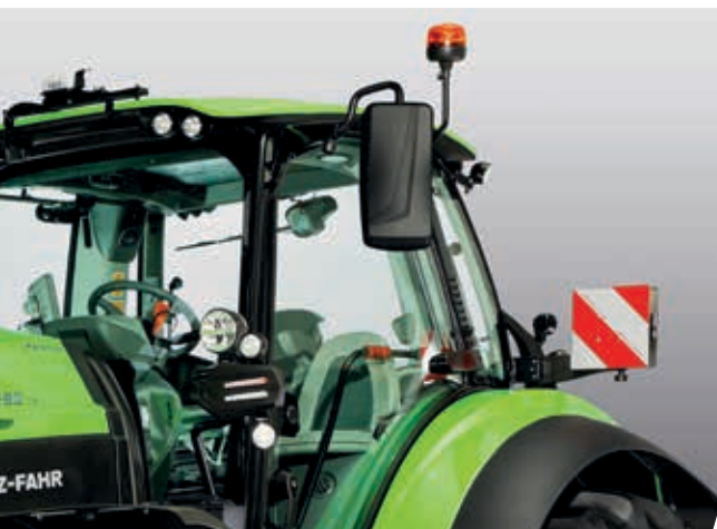
> Nowe, większe o 65% lusterka XLargeVision i pakiet widoczności wewnętrznej znacznie poprawiają widoczność w zakresie 360 stopni.
