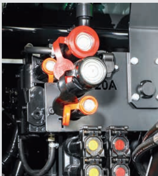
↑ Power Beyond z płaskimi złączami czołowymi zapewniającymi czyste połączenia.
