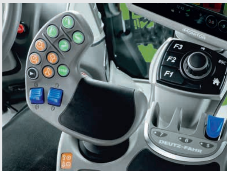
↑ Ergonomiczny joystick MaxCom z przednim oraz tylnym podnośnikiem, silnik, przekładnia, uwrocie oraz dwie jednostki sterujące proporcjonalnymi zaworami hydraulicznymi.
