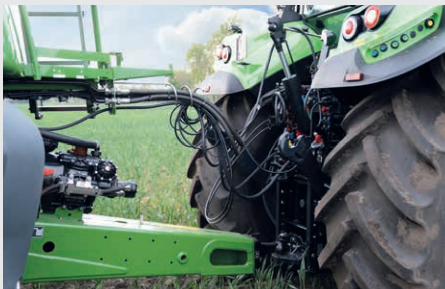
↑ Tylny zaczep w pozycji transportowej, dzięki czemu mniej koliduje z dyszlami podczas skręcania.
