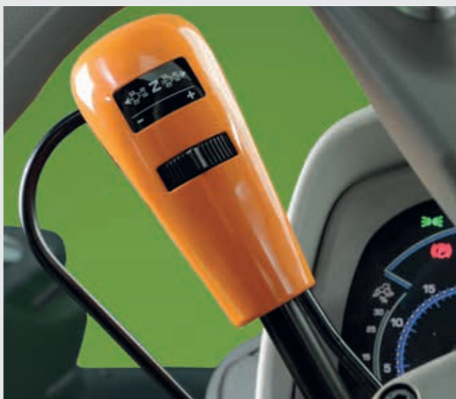
↑ Rowers PowerShuttle ze sprzęgłem Sense Clutch oraz pięć ustawień zmiany kierunku.
