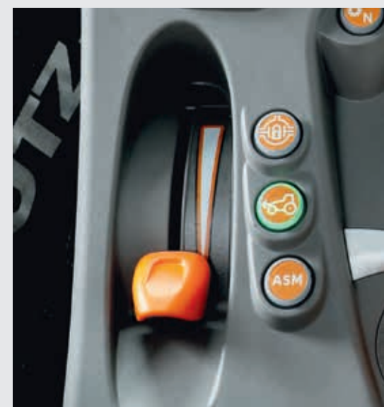
↑ Niezależna przepustnica ręczna oraz elektryczno-hydrauliczna aktywacja blokady układu różnicowego, napęd na wszystkie koła oraz automatyczna funkcja ASM.
