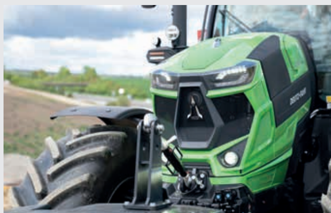
↑ Ledowe reflektory do jazdy oraz charakterystyczne, ledowe światła robocze.
