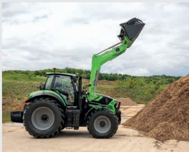
↑ Ogromna wysokość wykopu 4,5 m.
