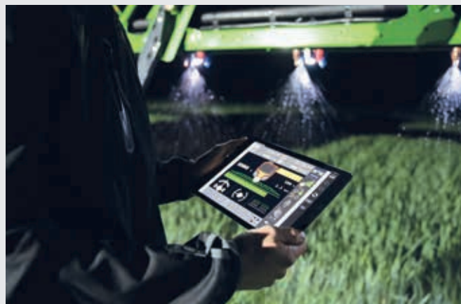
↑ Funkcja XTEND z tabletem, kontrola narzędzi za pośrednictwem systemu ISOBUS UT ze stanowiska poza kabiną.
