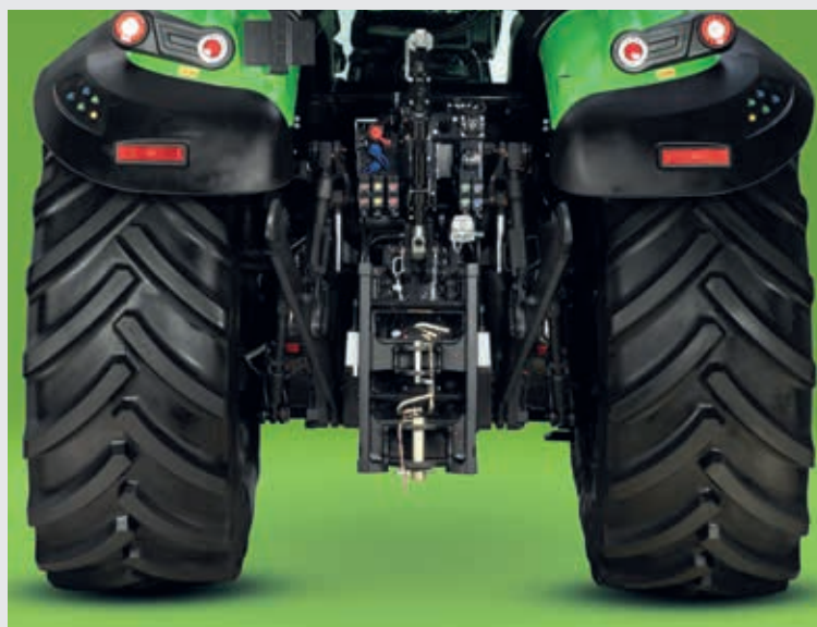
↑ Tylny zaczep, pięć tylnych zaworów suwakowych, zewnętrzne panele sterowania na błotnikach z obu stron.
