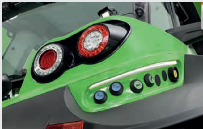
↑ Panele sterownicze na błotnikach z obu stron, podświetlone listwą LED.
