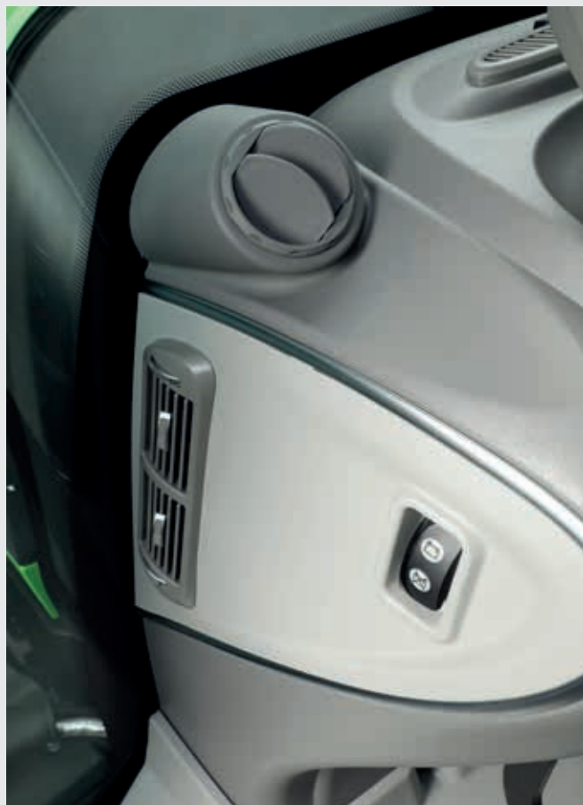
↑ Dodatkowe wyloty powietrza i główny wyłącznik akumulatora umieszczone wygodnie w kabine.
