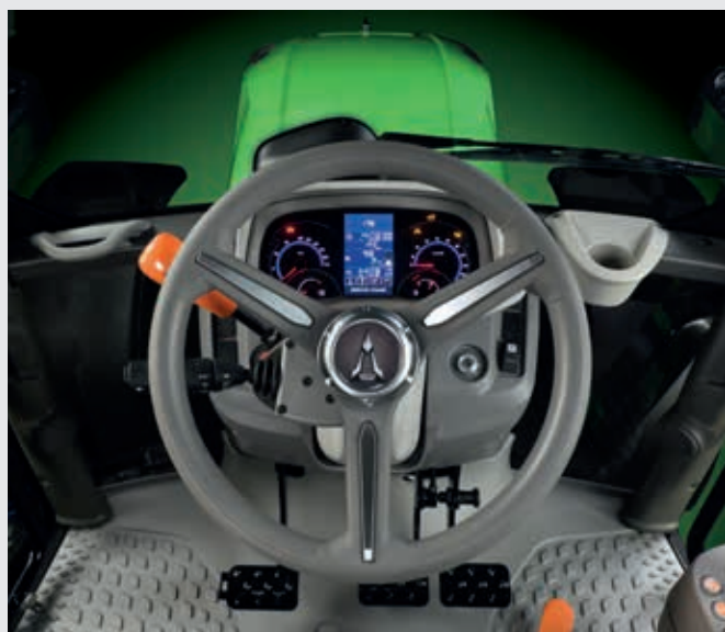
↑ Regulowana kierownica z InfoCentre Pro .
