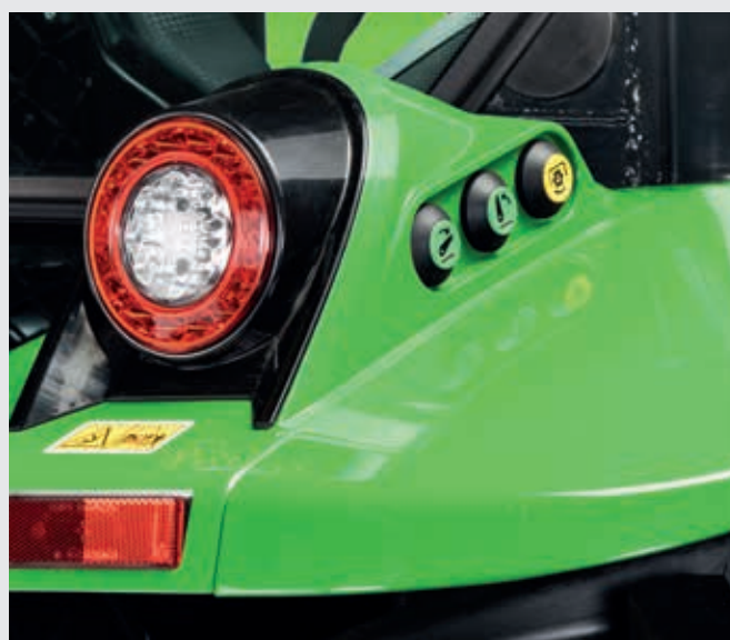
↑ Zewnętrzne elementy sterujące podnośnika tylnego oraz WOM.
