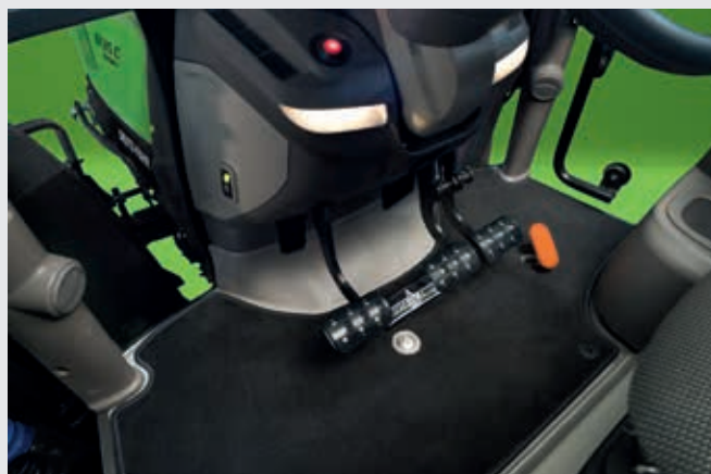
↑ Włączanie hydraulicznego hamulca silnikowego.
