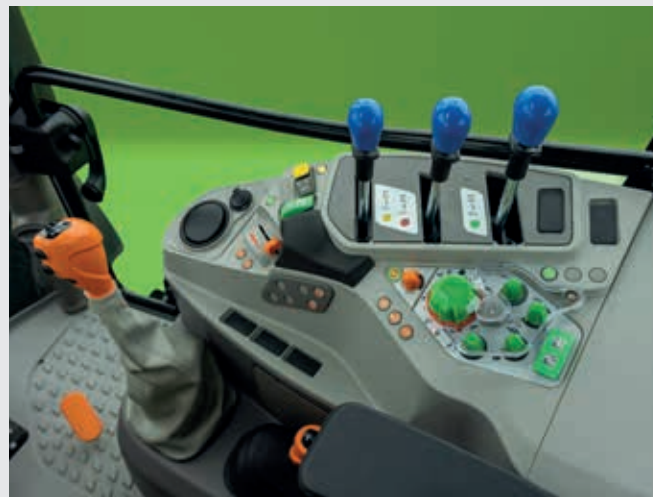
↑ Konsola przekładni Powershift 6125 C i 6135 C.
