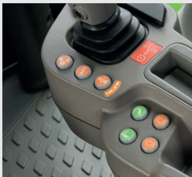
↑ Wybór zakresu: Pole, Transport, Reduktor.
