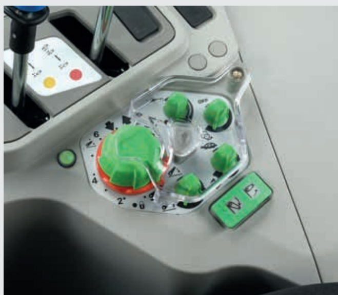
↑ Tylny podnośnik elektroniczny.
