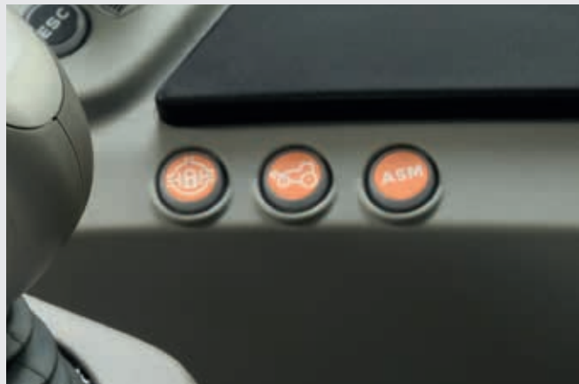
↑ Elektrohydrauliczne sterowanie osią przednią.
