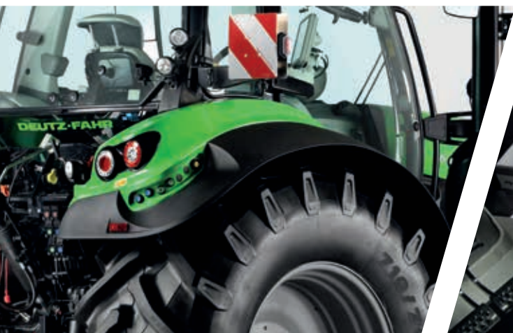
> Przyciski do sterowania tylnego podnośnika, WOM i jednego obwodu hydraulicznego.
