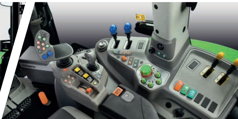
> Konfiguracja mieszana z 2 obwodami mechanicznymi i 2 elektronicznymi.
