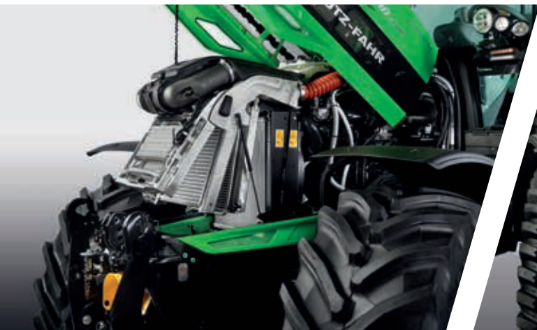
> Aluminiowy układ chłodzenia Performance + z dźwignią zwalniającą obsługiwaną jedną ręką do modeli 6160-6190.
