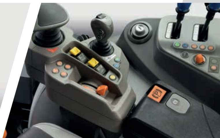
> Elektroniczny hamulec postojowy (EPB) w modelach TTV.
