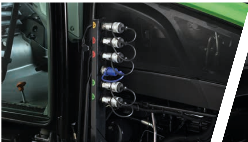
> Do 5 międzyosiowych przewodów hydraulicznych.
