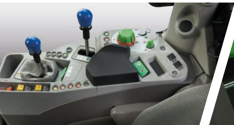
> Rozdzielacze tylne sterowane za pomocą pojedynczych dźwigni lub mechanicznych dźwigni krzyżowych.
