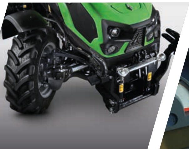
> Duży kąt skrętu kół dzięki niezależnemu zawieszeniu przedniej osi.
