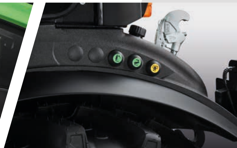
> Zewnętrzne przyciski tylnego podnośnika i WOM ułatwiające manewrowanie sprzęgiem z ciągnikiem.
