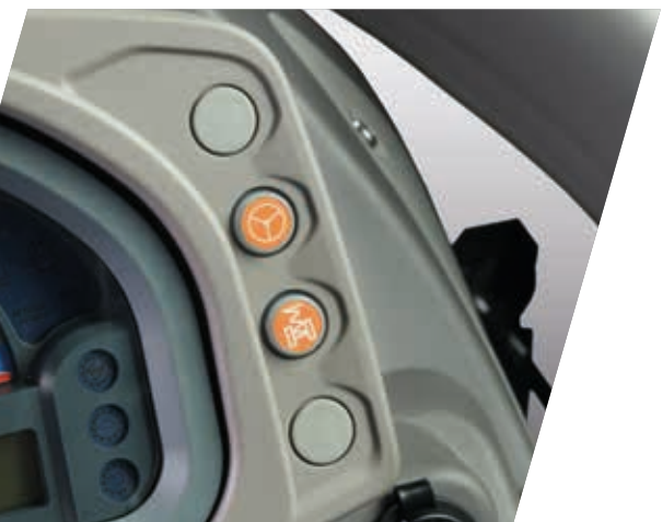
> Funkcja SDD zmniejsza o połowę liczbę obrotów kierownicy wymaganych do uzyskania pełnego skrętu w lewo do pełnego skrętu w prawo.
