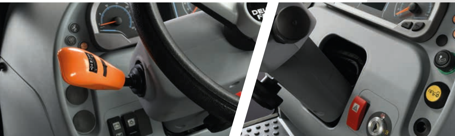
> Przekładnia PowerShuttle ze sprzęgłem SenseClutch (5 regulowanych poziomów).
