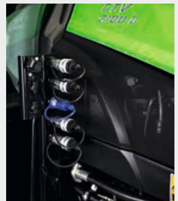
↑ Obwody hydrauliczne montowane centralnie do maszyn przednich.
