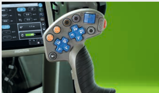
↑ Joystick MaxCom umożliwia łatwą obsługę przekładni TTV.
