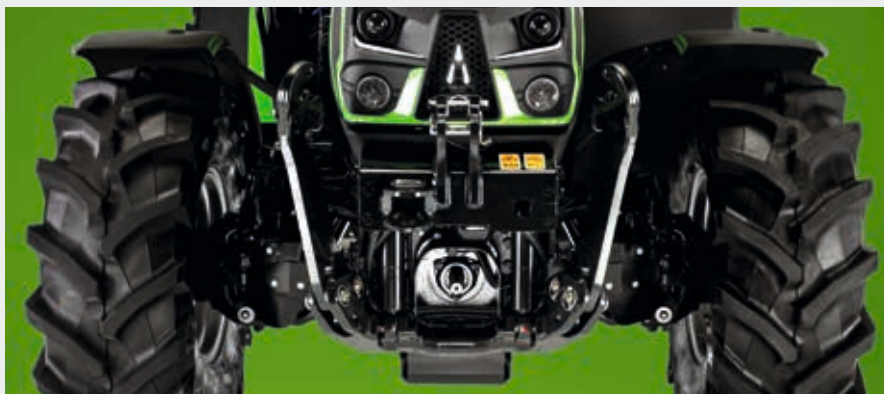
↑ Modele 5D TTV można wyposażać w przedni podnośnik o udźwigu 2100 kg oraz w opcjonalny pakiet Comfort.
