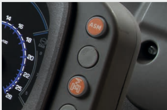
↑ Włączniki systemu ASM i amortyzacji przedniej osi.
