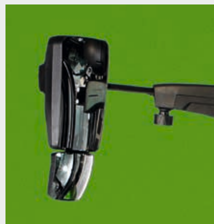
↑ Lusterka z elektryczną regulacją i ogrzewaniem.
