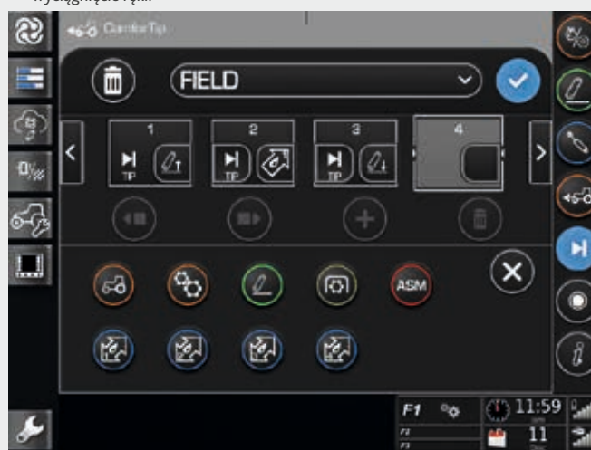
↑ Comfortip dodatkowo zwiększa poziom komfortu. Umożliwia zapisywanie w pamięci powtarzanych zadań oraz ich wywołanie przez naciśnięciem przycisku.
