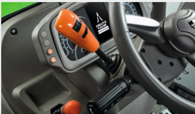
↑ SenseClutch: możliwość konfiguracji reakcji rewersu.
