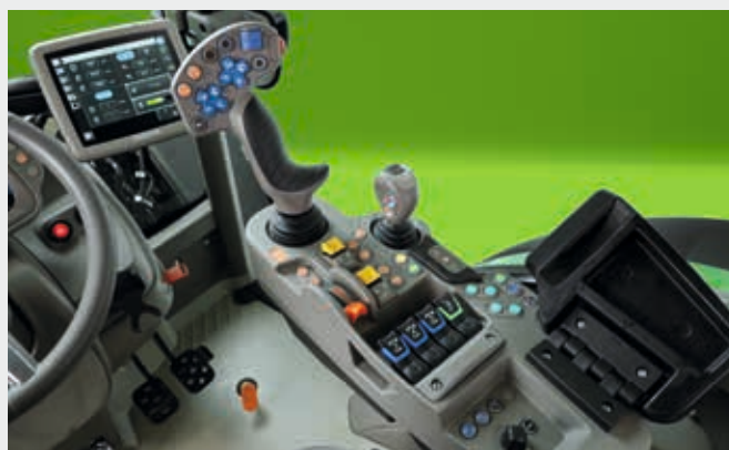
↑ Podłokietnik MaxCom z intuicyjnie rozmieszczonymi sterownikami.
