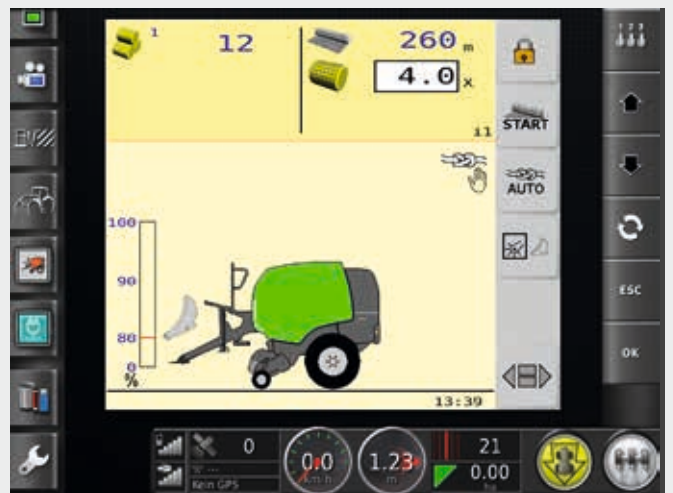
↑ Uniwersalny terminal do kontroli wszystkich narzędzi ISOBUS.
