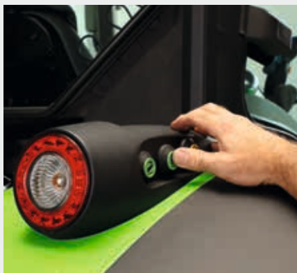
↑ Tylny podnośnik i WOM mają przyciski sterujące na tylnych błotnikach.
