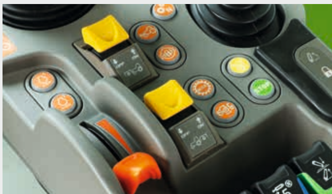
↑ łatwe załączenie przedniego i tylnego WOM przyciskami na podtokiećniku MaxCom.
