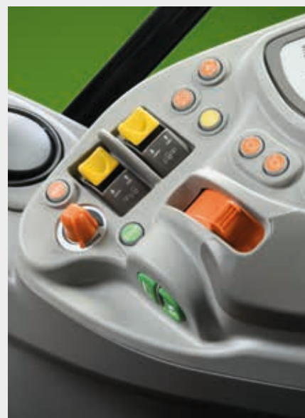
↑ Przedni i tylny WOM łączone elektrohydraulicznie z funkcją AUTO WOM.
