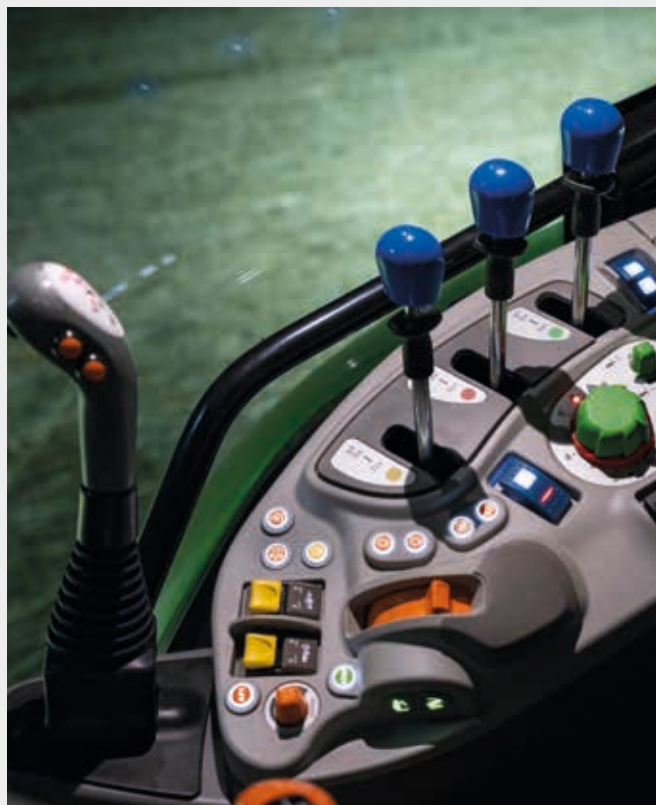
↑ Podświetlana prawa konsola zapewnia doskonałą widoczność w nocy.
