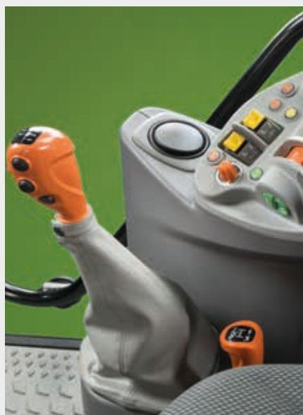
↑ Sterowanie póżbiegami Powershift i automatyczna zmiana w funkcji APS.
