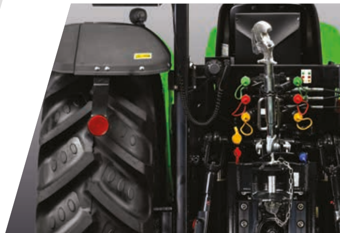
> Nawet 3 obwoły z regulatorem przepływu i wolnym sptywem.
