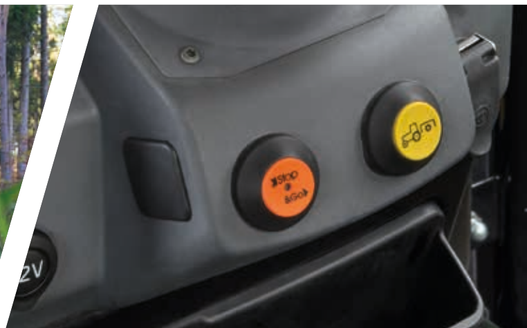
> Elektrohydrauliczne załączanie WOM w modelach z PowerShuttle.
