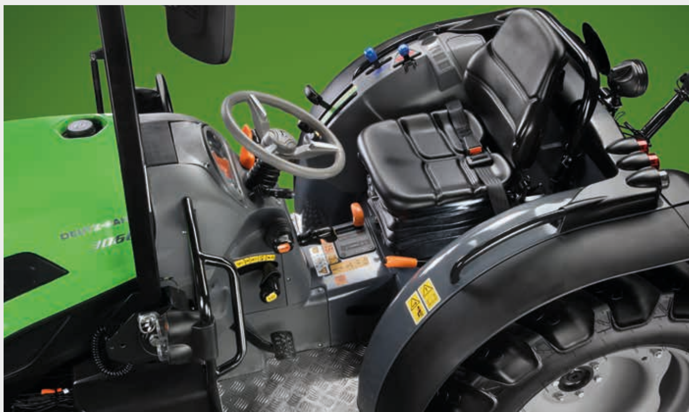
↑ Wersja ROPS z platformą zawieszoną na tulejach Silent-Block.
