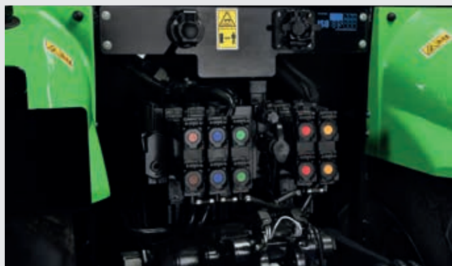
↑ Do 5 elektronicznie sterowanych obwodów tylnych.
