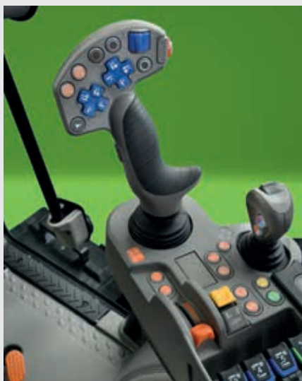
Joystick MaxCom umożliwiający łatwe zarządzanie prędkością jazdy.
