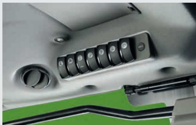
↑ Ochrona przed chemią, zapewniona dzięki filtracji kat. 4, może być łatwo aktywowana za pomocą przycisku.
