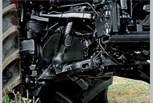
Niezależny, wielo-wahaczowy układ amortyzacji kół przedniej osi zapewnia doskonałą trakcję i najwyższy komfort jazdy.
