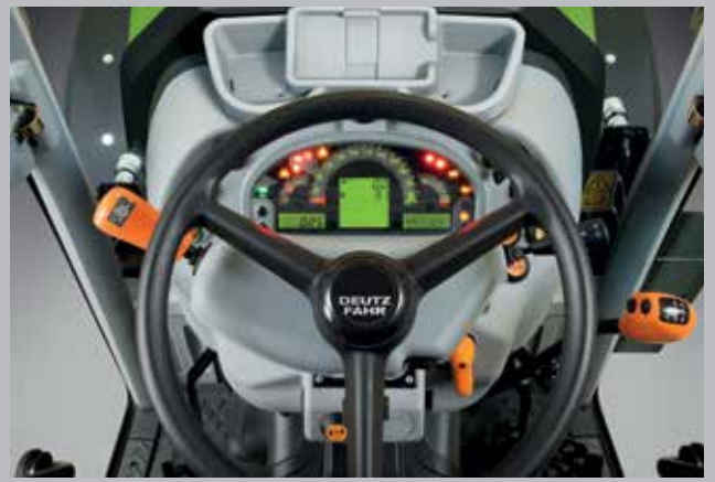
InfoCenter. Doskonały podgląd na wszystkie parametry pracy na wskaźnikach analogowych i wyświetlaczu cyfrowym.
