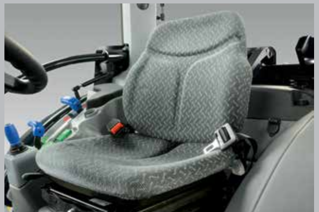
Fotel operatora amortyzowany mechanicznie lub pneumatycznie.
