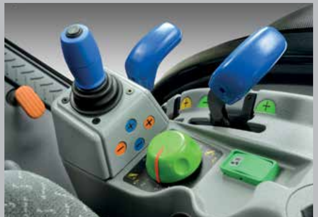
Pokrętło sterowania tylnego podnośnika elektronicznego EHR. Joystick do sterowania 2 obwodów hydrauliki.
