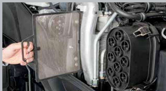
Wydajność silnika wspiera zaprojektowany od podstaw pakiet chłodnic. Zwiększo- no też przepływ powietrza przez filtr PowerCore.
