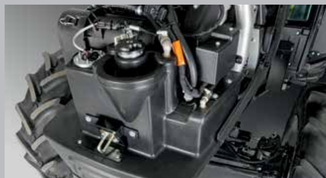
Zbiornik paliwa zabudowany w przedniej części komory silnika może być napełniany bez otwierania maski silnika dzięki dodatkowej pokrywie z przodu ciągnika.
