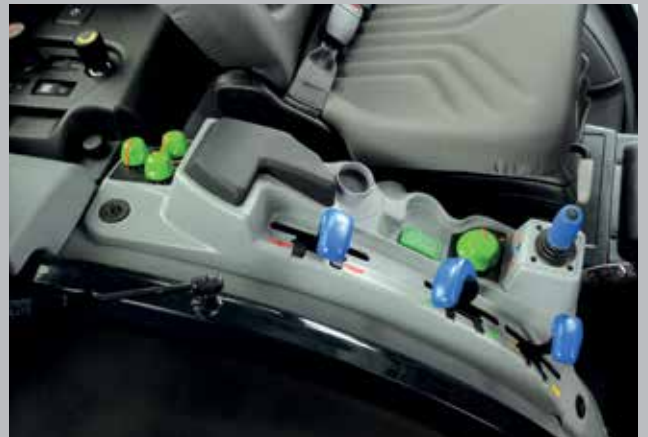
Dźwignie sterowania układem hydraulicznym oraz pokrętła do obsługi tylnego podnośnika umieszczone tuż obok fotela operatora.
