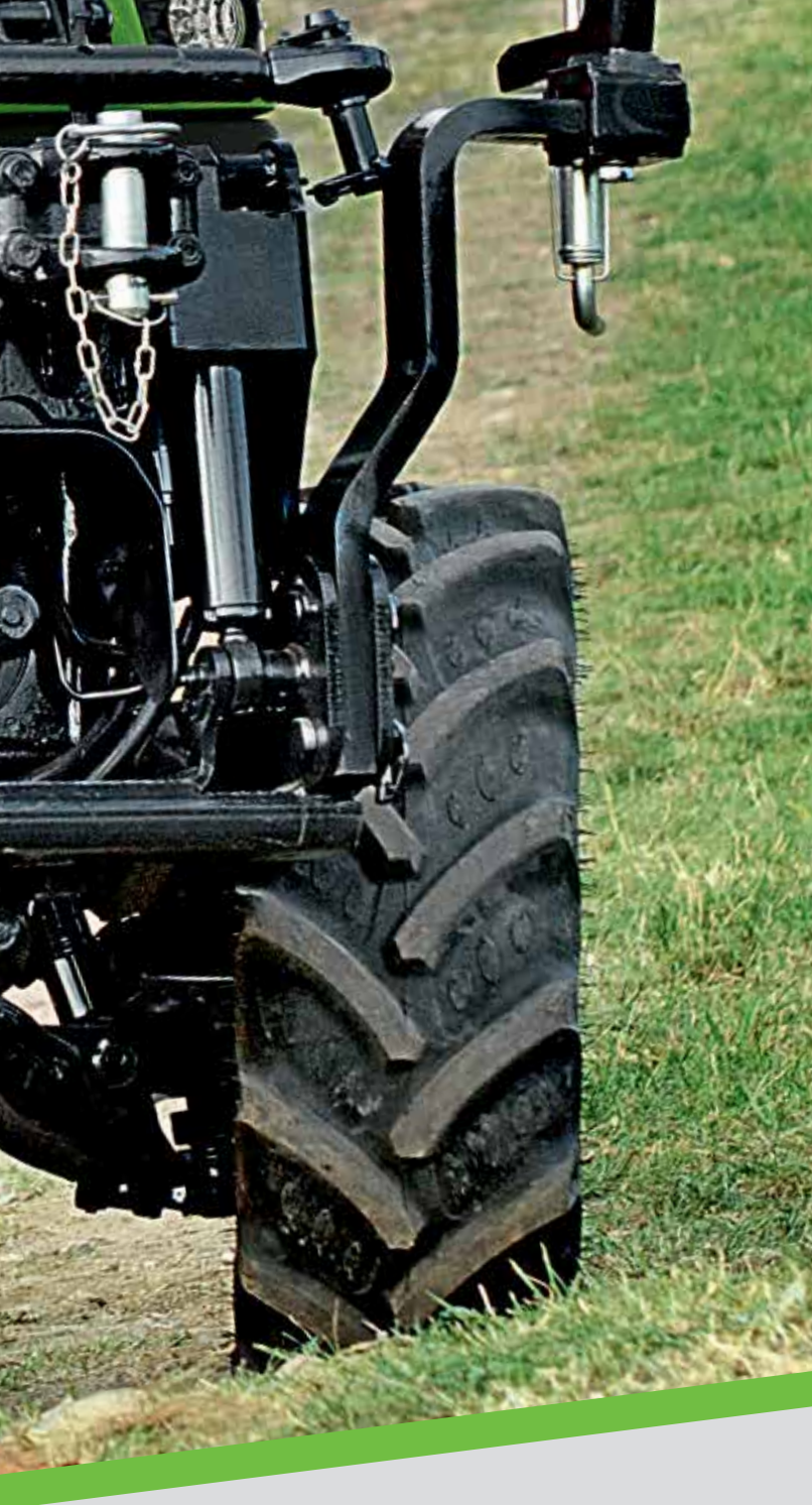
Nowy wspornik przedniej osi zapewnia duży kąt skrętu kół ciągnika, co przekłada się na świetną zwrotność w pracach w wąskich międzyrzędziach.
