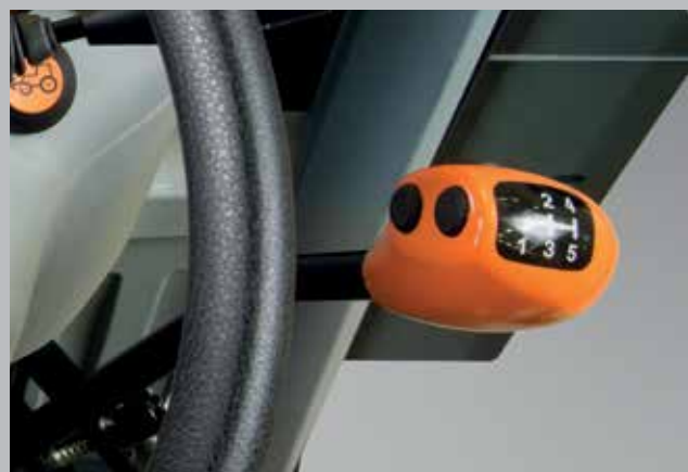
PowerShift. Skrzynia z półbiegami pod obciążeniem. Przyciski zmiany półbiegów i sprzęgła Comfort Clutch na dźwigni zmiany biegów.
