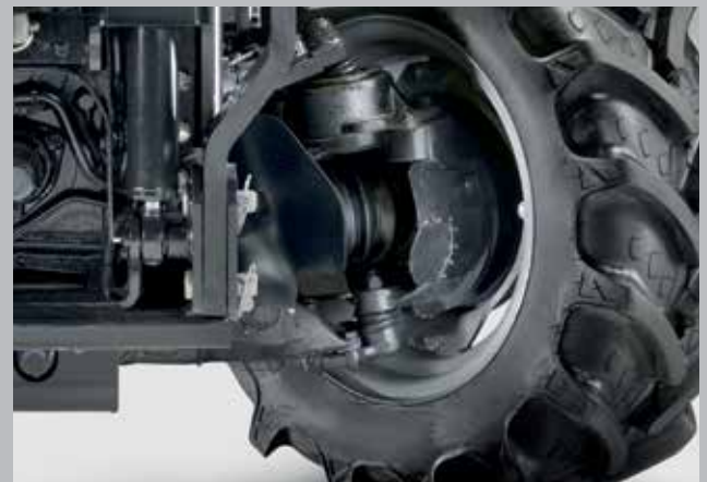
Układ hamulcowy na cztery koła i zawór rozłączania hamulców kół przedniej osi. Bezpieczeństwo na pierwszym miejscu.
