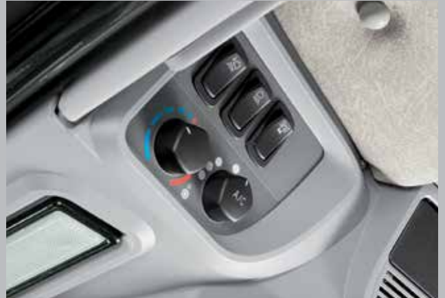
Prosty w obsłudze panel sterowania układem klimatyzacji z czytelnymi pokrętkami umieszczono pod dachem kabiny.
