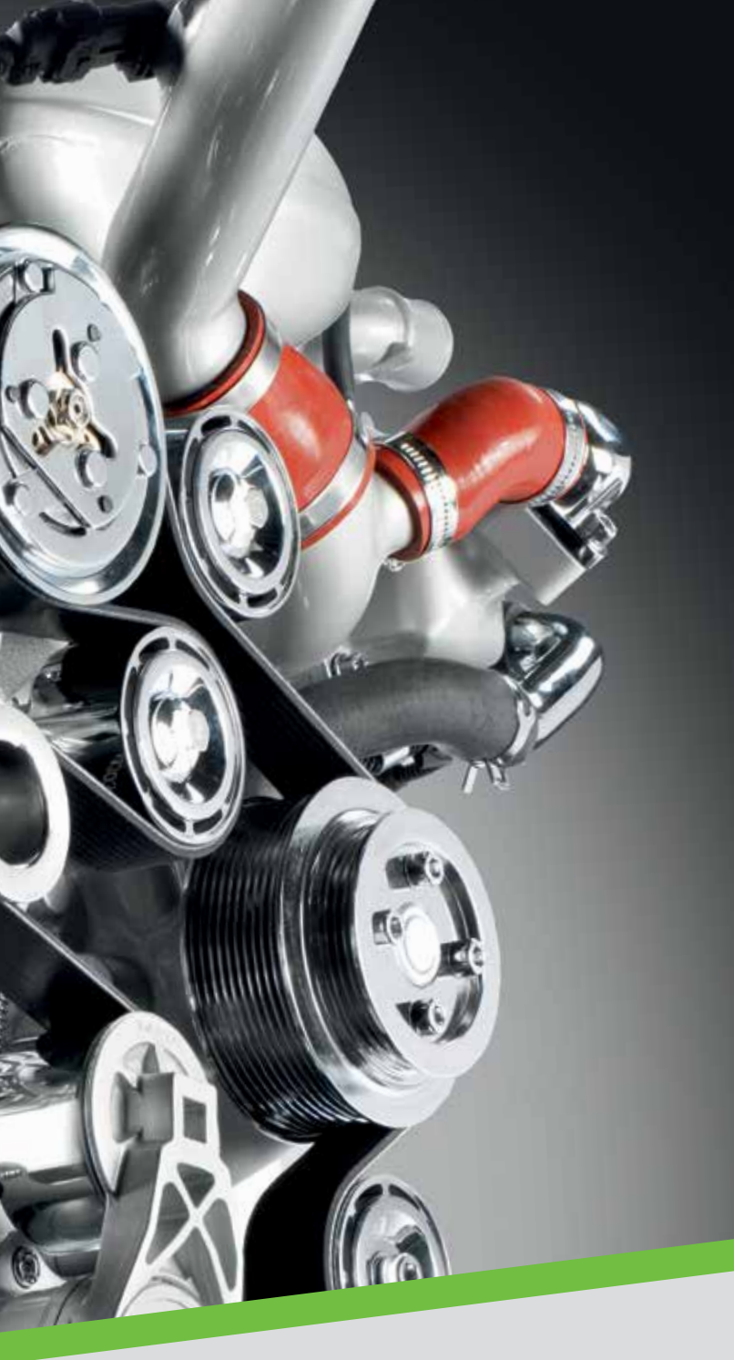
Wydajność silnika wspiera zaprojektowany od podstaw pakiet chłodnic. Zwiększo- no też przepływ powietrza przez filtr PowerCore.
