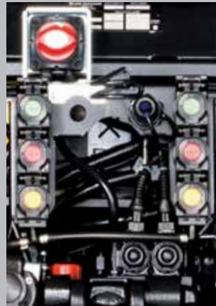
Maksymalnie po 3 obwody układu hydraulicznego z tyłu oraz centralnie przy kabinie ciągnika. Powrót oleju oznaczony kolorem niebieskim.
