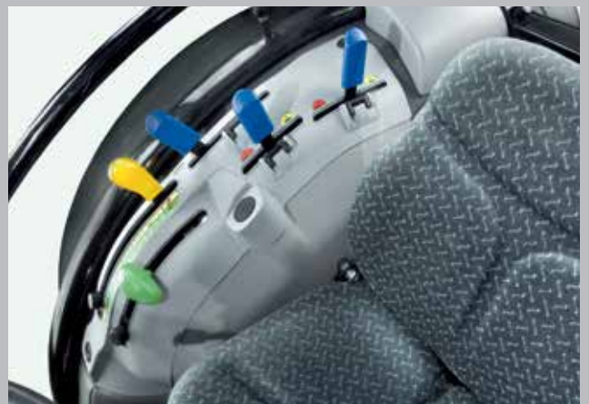
Dźwignie sterowania funkcjami podnośnika tylnego w wersji mechanicznej.
