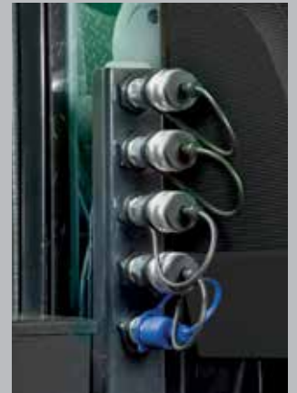
Maksymalnie po 3 obwody układu hydraulicznego z tyłu oraz centralnie przy kabinie ciągnika. Powrót oleju oznaczony kolorem niebieskim.
