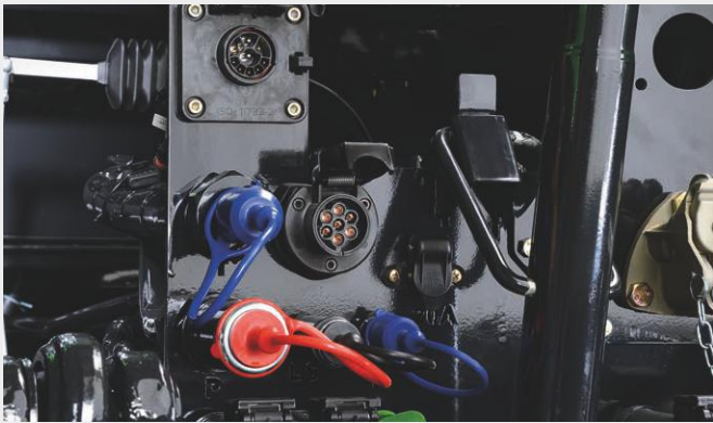
↑ Gniazda ISOBUS montowane z przodu i z tyłu ciągnika – obsługa maszyn różnych producentów.
