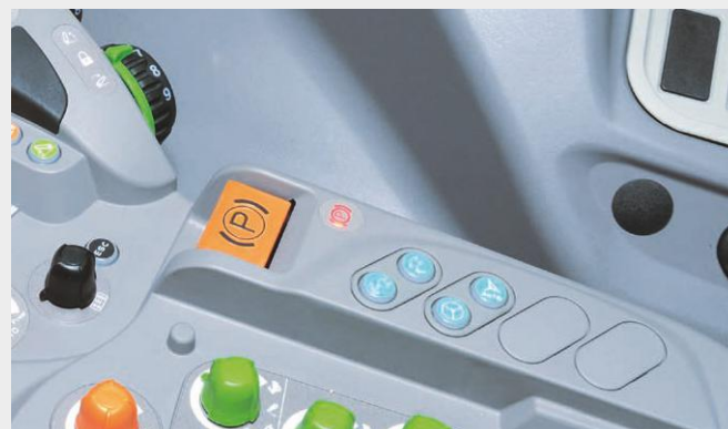
↑ EPB: elektroniczny hamulec postojowy z trybami automatycznego uruchamiania.
