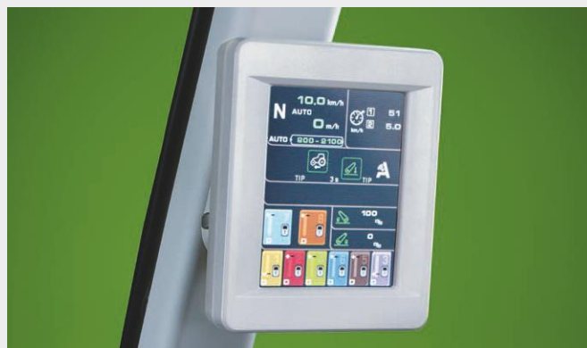
↑ Trzy tryby pracy układu napędowego: manual, auto i WOM. Informacje o działaniu skrzyni na wyświetlaczu na słupku kabiny.
