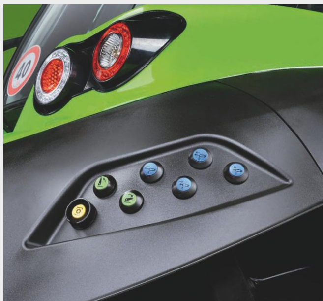
↑ Przyciski sterowania hydrauliką, WOM i podnośnikiem na błotnikach.
