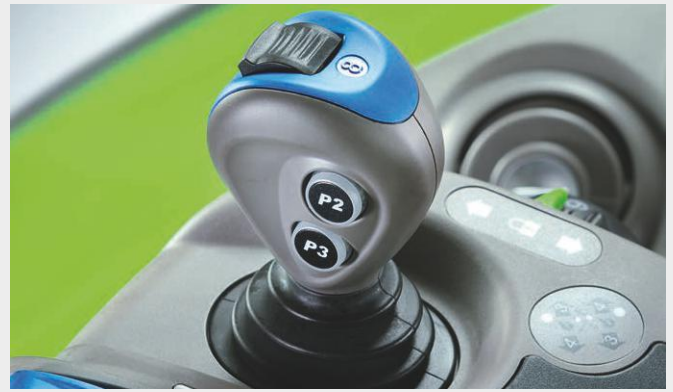
↑ Joystick do sterowania obwodami układu hydraulicznego na podłokietniku.
