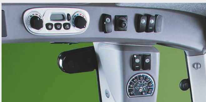
↑ Wszystkie reflektory sterowane za pomocą przycisków na panelu na słupku kabiny. Rozbudowany układ klimatyzacji utrzymuje zadaną temperaturę wnętrza.
