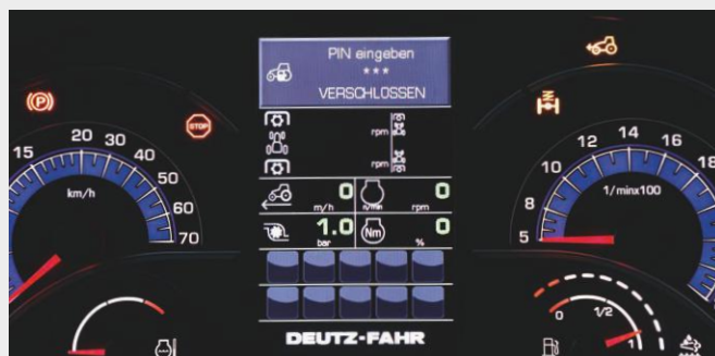
↑ Deska rozdzielcza z panelem InfoCenterPro oferuje wskaźniki analogowe i wyświetlacz cyfrowy. Ciągnik posiada dodatkowe zabezpieczenie w postaci kodu PIN przed uruchomieniem.
