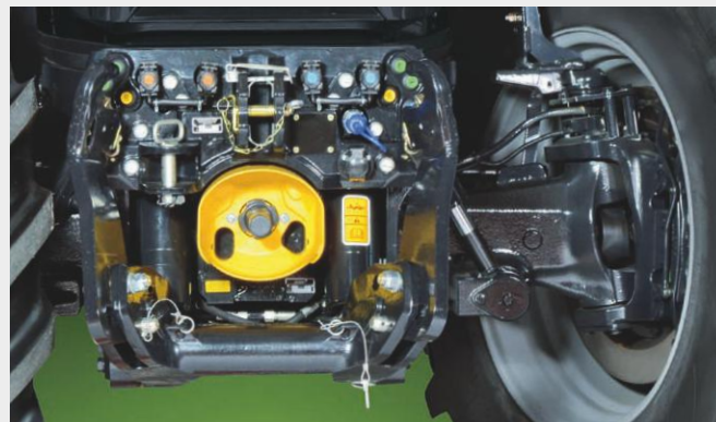
↑ Oś przednia: duży skok układu amortyzacji przy zachowaniu 50° kąta skrętu kół.
