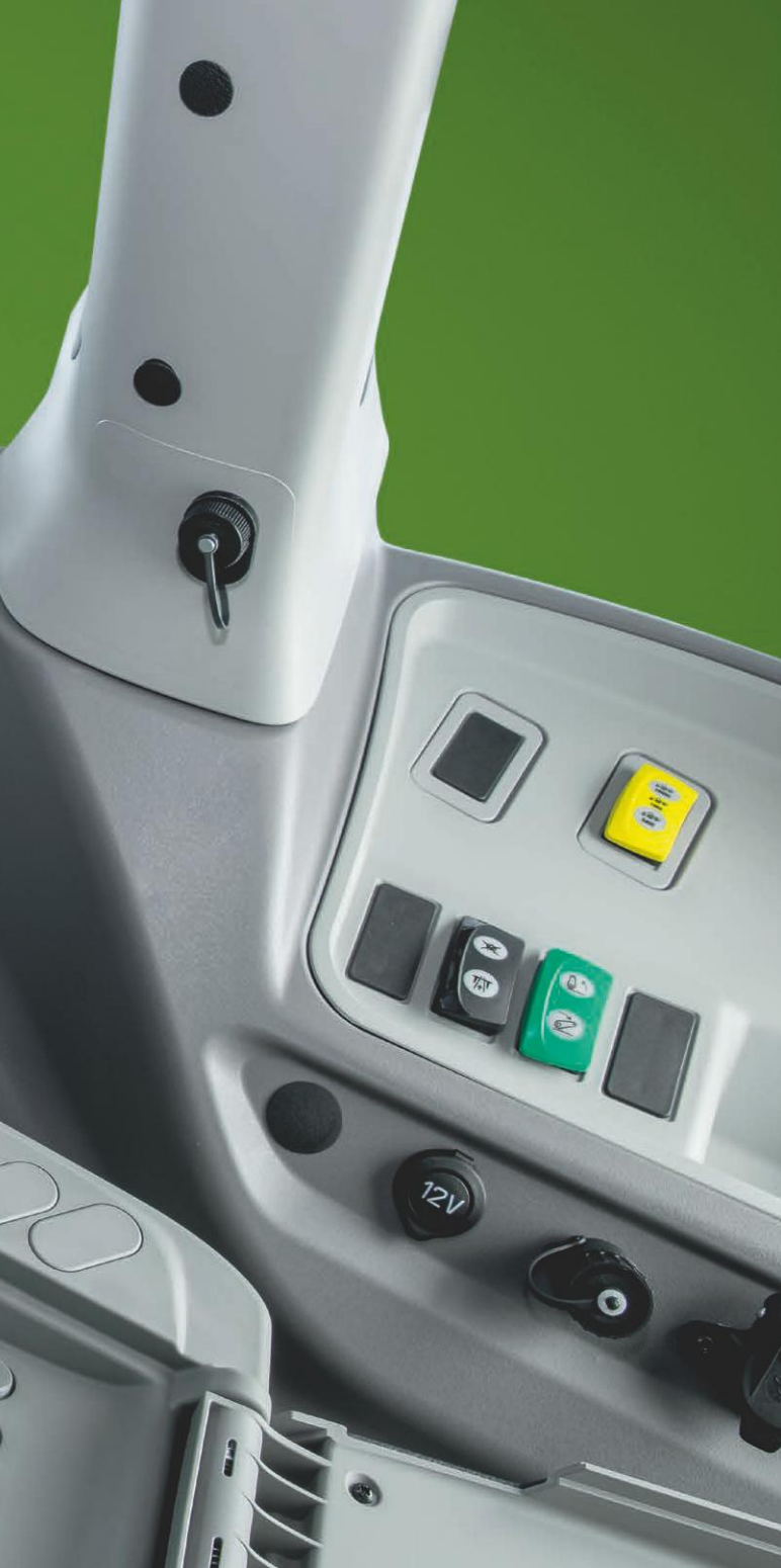
↑ Joystick do sterowania obwodami układu hydraulicznego na podłokietniku.
