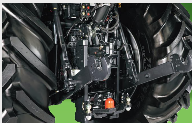
↑ Ramiona podnośnika posiadają pozycję transportową.
