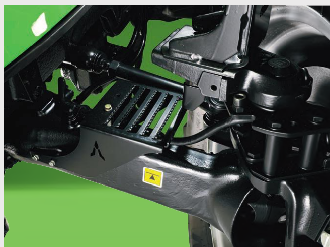
↑ Stopnie nad przednią osią zapewniają bezpieczeństwo w trakcie obsługi.
