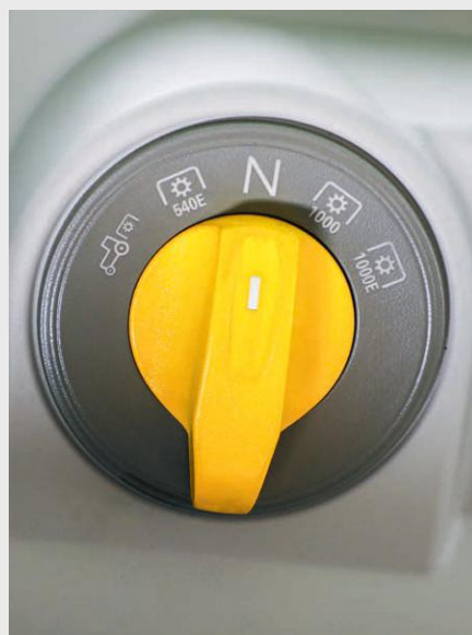
↑ Elektrohydrauliczny wybór prędkości WOM.
