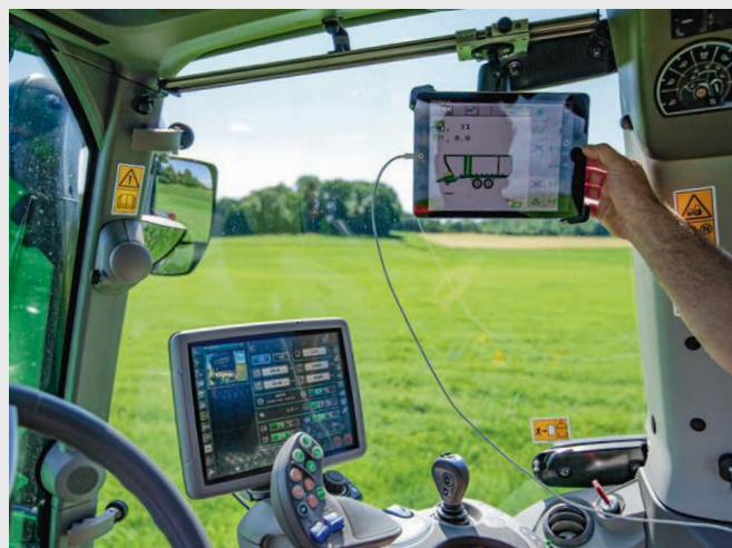
↑ Szyna montażowa do podłączenia monitorów zewnętrznych.
