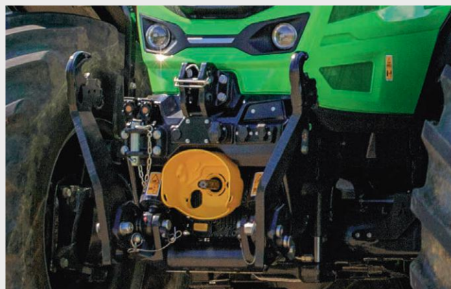
↑ 5450 kg udźwigu oraz przedni WOM z technologią Dual Speed.
