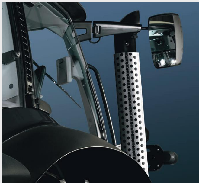
↑ Osłona rury wydechowej ze stali nierdzewnej.
