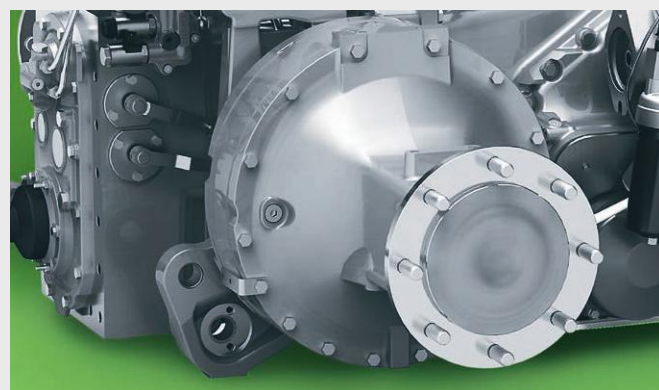
↑ Skrzynia z przekładniami planetarnymi oraz hydrostatem.
