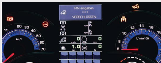
↑ Zestaw wskaźników i panel InfoCenterPro. Informacje o wszystkich parametrach użytkowych ciągnika. Blokada – immobiliser z kodem PIN.
