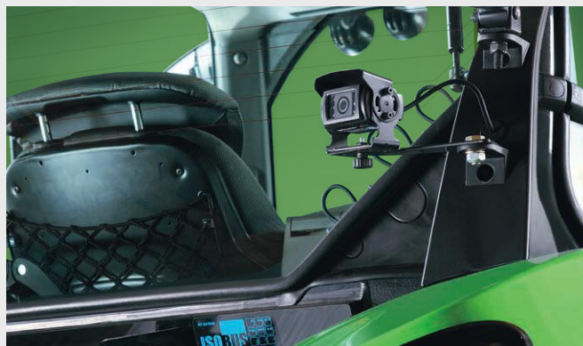
↑ Zintegrowana kamera podająca obraz na iMonitor w kabinie.
