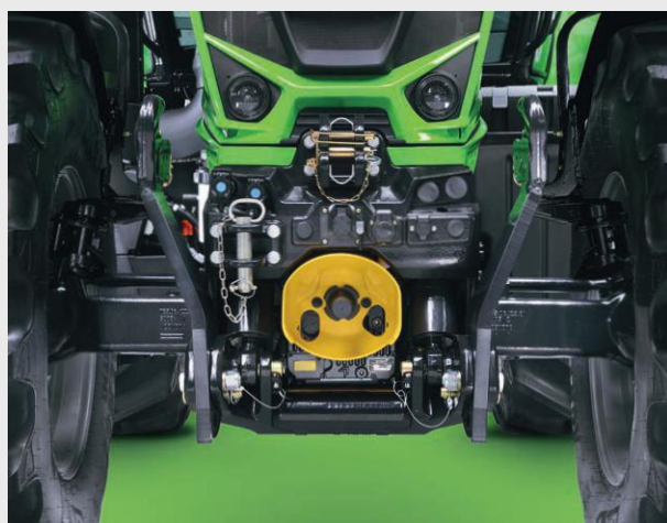
↑ Maksymalnie 5 obwodów montowanych z tytu i z przodu. Nowy, zintegrowany podnośnik przedni.
