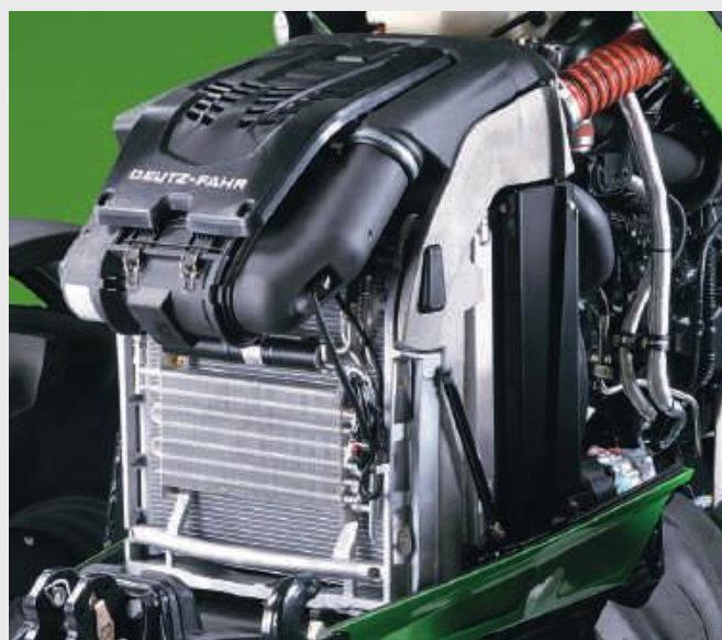
↑ Technologia PowerCore: 20% większa przepustowość filtra powietrza.
