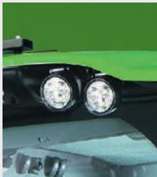
↑ Maksymalnie 16 reflektorów LED (generacja IV, 2500 lumenów/reflektor).
