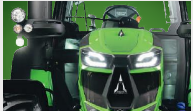
↑ Pakiet LED z reflektorami o mocy 2500 lumenów każdy (zależnie od modelu).
