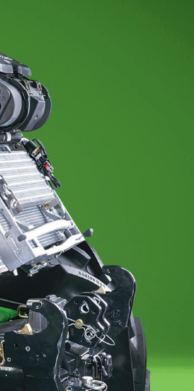
↑ Wstępne czyszczenie powietrza podawanego do filtra: spiralne kanaliki pozwalają usunąć 95% drobin kurzu i innych zanieczyszczeń.
