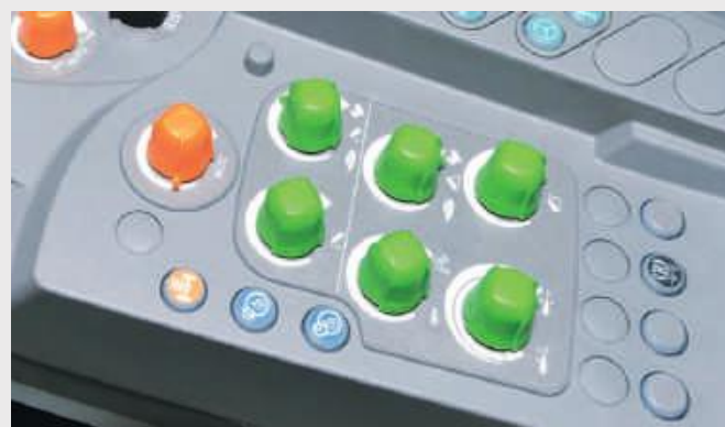
Przedni podnośnik elektroniczny (tylko w TTV) oraz tylny EHR sterowane pokrętkami na podłokietniku.
