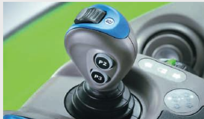
Hydraulika z regulacją czasu i wydatku oleju. Joystick do obsługi wszystkich funkcji ładowacza czołowego.
