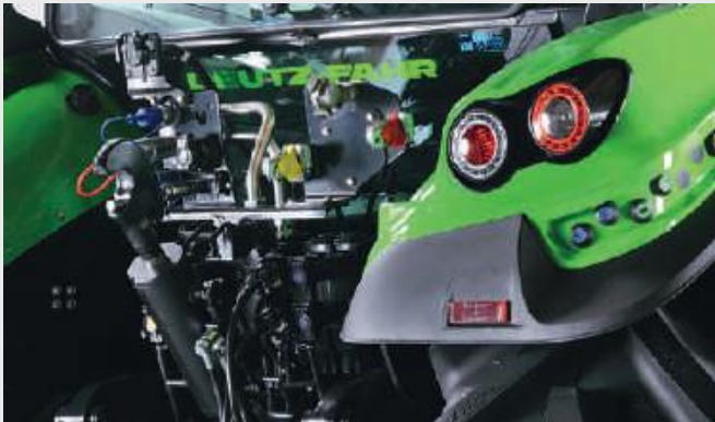
↑ Skuteczny i bezpieczny układ pneumatycznych hamulców przyczep.
