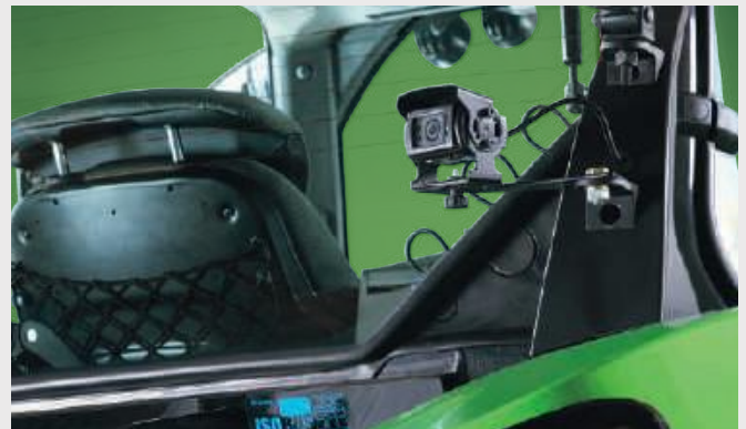
↑ Zintegrowana kamera z obsługą przez iMonitor zwiększa bezpieczeństwo.
