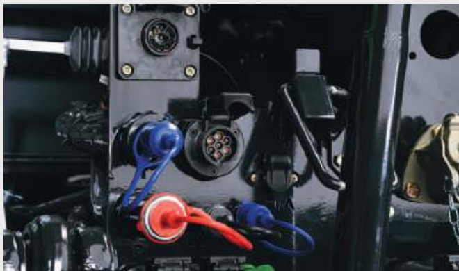
↑ Gniazda ISOBUS z przodu i z tyłu ciągnika do obsługi maszyn różnych producentów.
