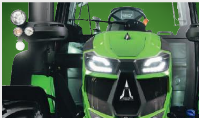
↑ Pakiet LED z reflektorami o mocy 2500 lumenów każdy (zależnie od modelu).
