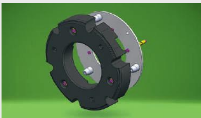
↑ Obciążniki kół tylnych do 1340 kg zwiększają trakcję ciągnika.
