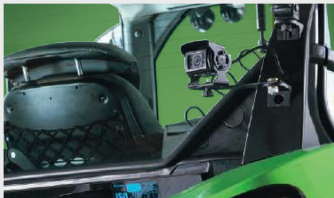
↑ Zintegrowana kamera z obsługą przez iMonitor zwiększa bezpieczeństwo.
