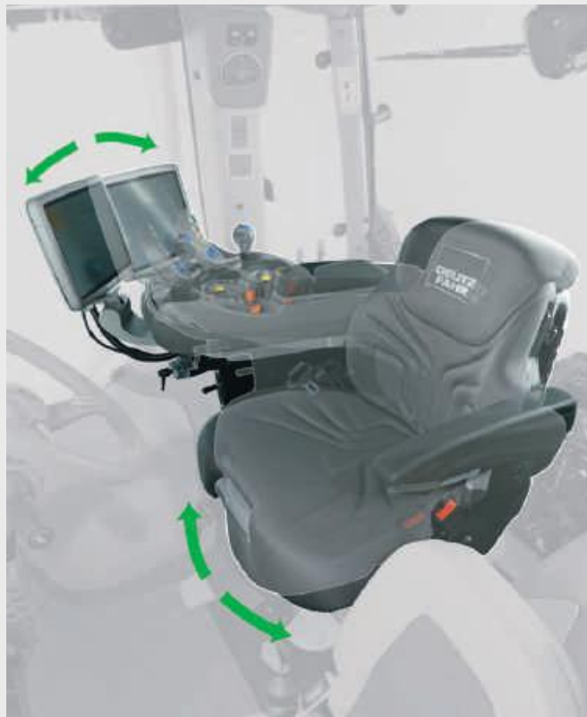
↑ Dostępny w modelach TTV: fotel z możliwością obrotu o 20° dla jeszcze większego komfortu pracy z maszynami.
