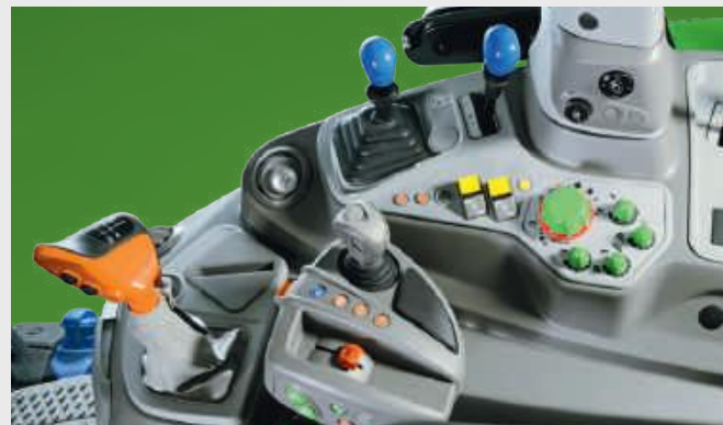
↑ Napęd Powershift: wydajna, uniwersalna skrzynia z manualną zmianą przełożeń.
