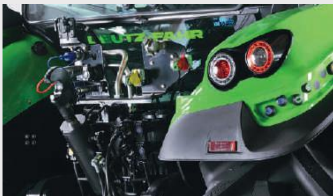
↑ Skuteczny i bezpieczny układ pneumatycznych hamulców przyczep.
