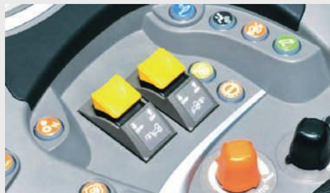
Przyciski do sterowania WOM pod ręką operatora w każdym wariancie kabiny.
