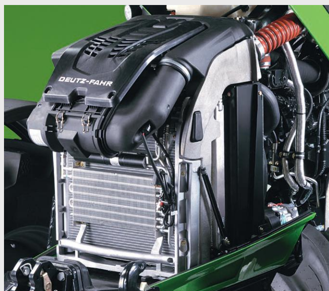
↑ Technologia PowerCore: 20% większa przepustowość filtra powietrza.
