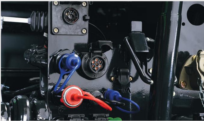
↑ Gniazda ISOBUS z przodu i z tyłu ciągnika do obsługi maszyn różnych producentów.
