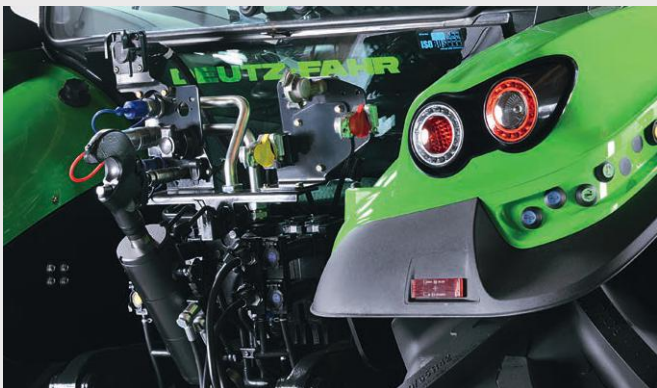
↑ Skuteczny i bezpieczny układ pneumatycznych hamulców przyczep.
