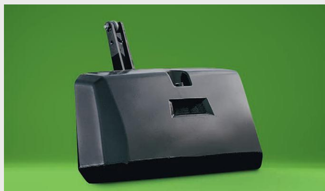
↑ Obciążnik przedni 1000 kg montowany na ramionach podnośnika.
