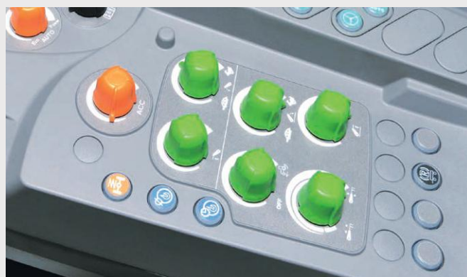
Przedni podnośnik elektroniczny (tylko w TTV) oraz tylny EHR sterowane pokrętkami na podłokietniku.
