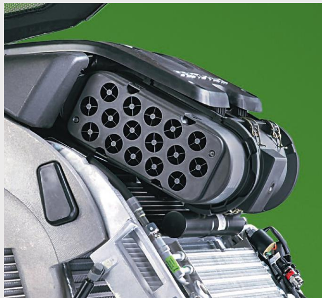
↑ Wstępne czyszczenie powietrza podawanego do filtra: spiralne kanaliki pozwalają usunąć 95% drobin kurzu i innych zanieczyszczeń.
