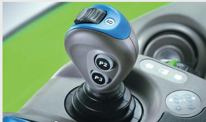
Hydraulika z regulacją czasu i wydatku oleju. Joystick do obsługi wszystkich funkcji ładowacza czołowego.
