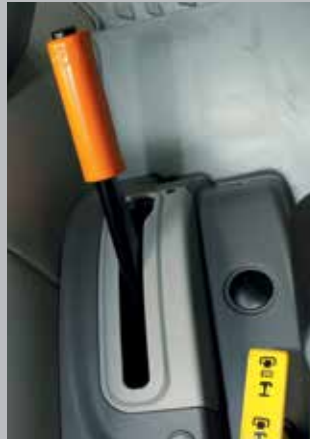
Mechaniczny lub hydrauliczny hamulec postojowy (HPB dostępny w modelach 5110G Plus i 5120 G).
