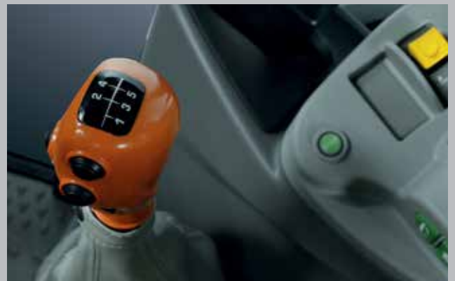
Przycisk sprzęgła ComfortClutch i przyciski zmiany pól biegów Powershift pod obciążeniem umieszczono na dźwigni zmiany biegów.
