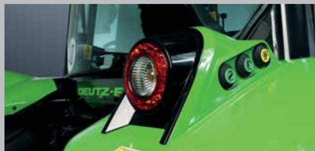
Przyciski sterowania WOM i podnośnikiem na błotnikach kabiny.
