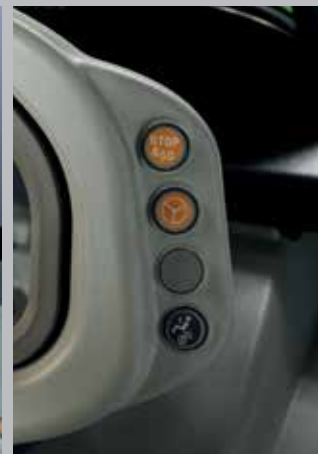
Joystick z przyciskami do zmiany półbiegów Powershift, przyciski funkcji Stop&Go, układu kierowniczego SDD ...
