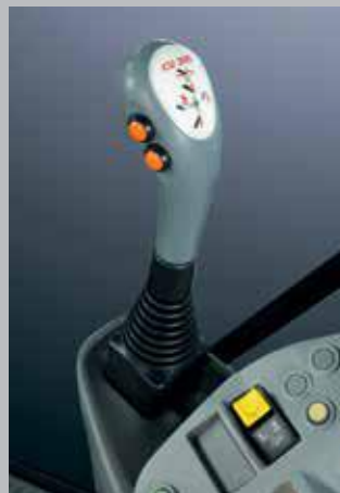
Joystick z przyciskami do zmiany półbiegów Powershift, przyciski funkcji Stop&Go, układu kierowniczego SDD ...
