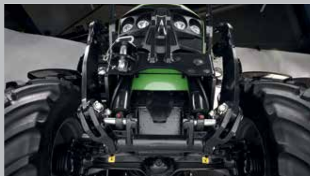
Opcjonalny przedni podnośnik i WOM. Udźwig maksymalny aż 2100 kg, prędkość obrotowa wałka 1000 obr./min.
