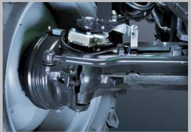
Bezpieczeństwo według DEUTZ-FAHR. Tarcze hamulcowe w kąpeli olejowej na czterech kołach ciągnika.
