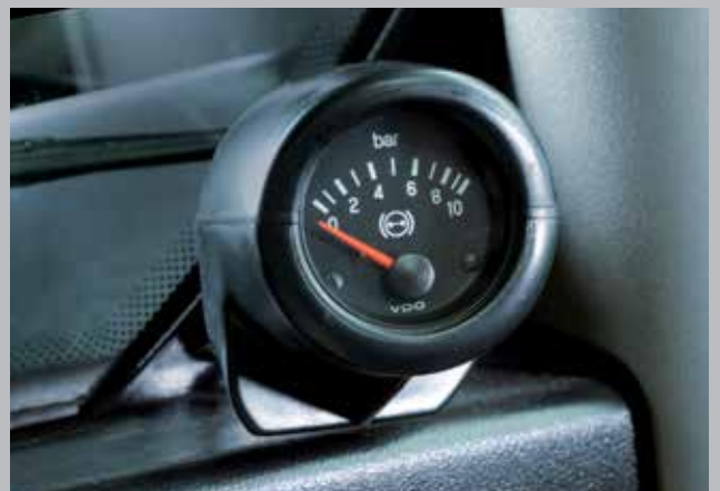
Wskaźnik ciśnienia w pneumatycznym układzie hamulcowym przyczep.
