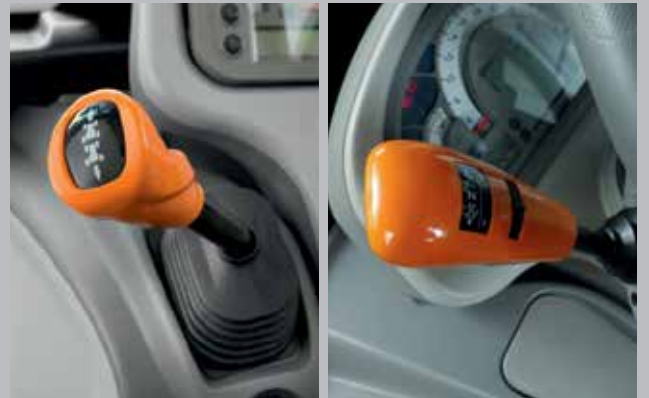
Rewers mechaniczny lub elektro-hydrauliczny Powershuttle z regulacją. W obydwu przypadkach dźwignia pod kołem kierownicy.
