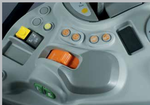
Dwie pamięci prędkości obrotowej silnika. Prosta obsługa maszyn w pracach polowych.
