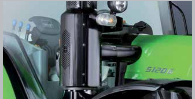
Katalizator utleniający (DOC) w modelach Stage IIIB lub selektywna redukcja katalizacyjna (SCR) w modelach Stage IV.
