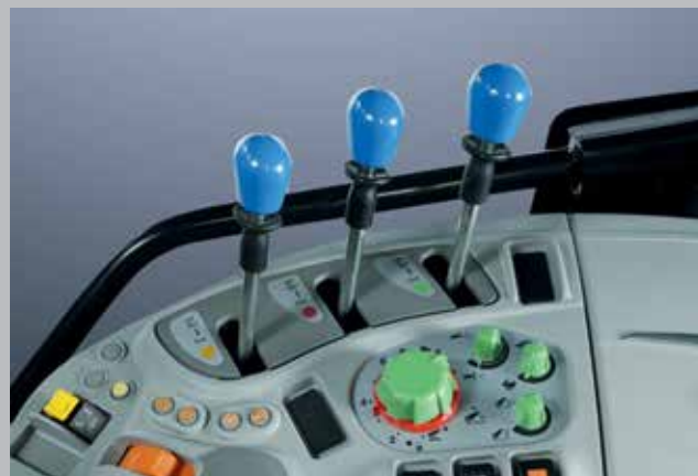
Dźwignie sterowania układem hydraulicznym. Precyzja i pewność w każdej pracy.
