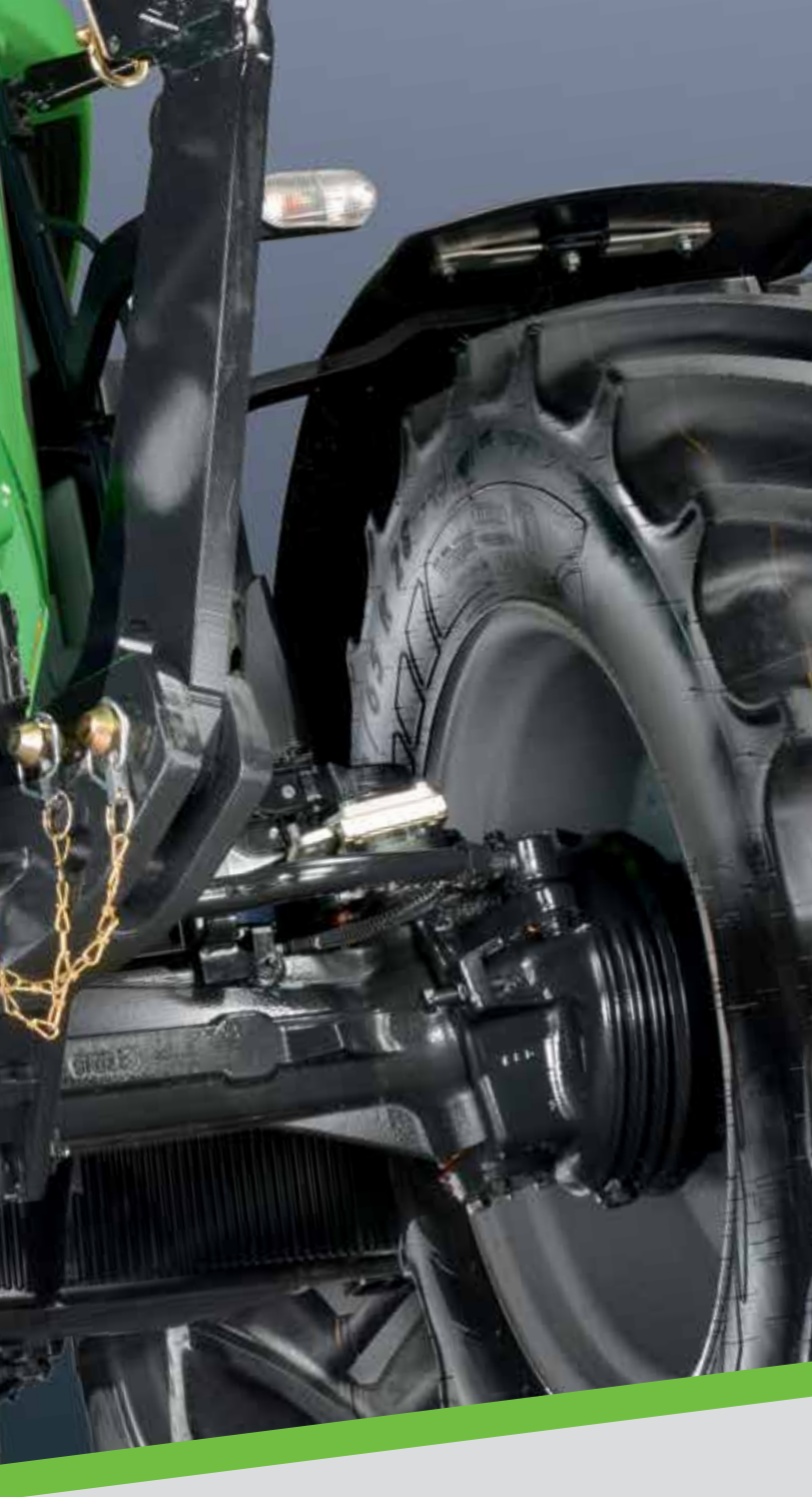
Bezpieczeństwo według DEUTZ-FAHR. Tarcze hamulcowe w kąpeli olejowej na czterech kołach ciągnika.
