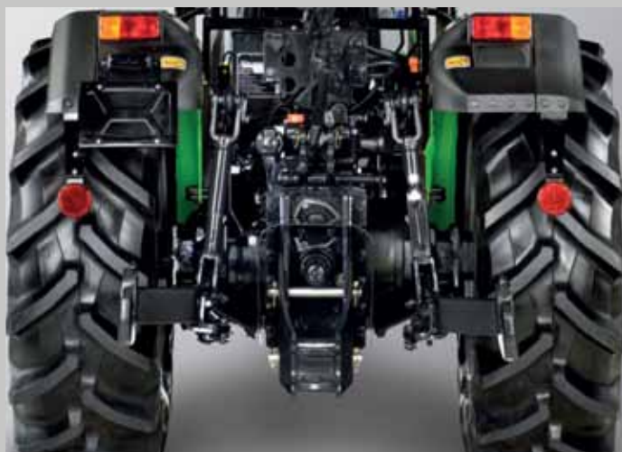
Mocny podnośnik i maksymalnie 3 obwody hydrauliki.
