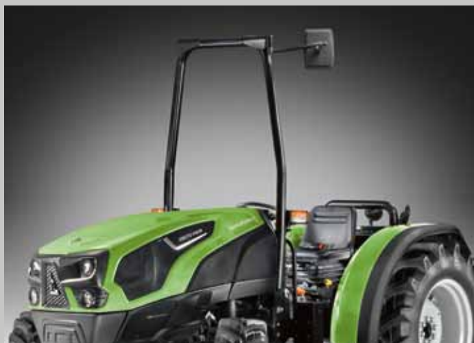
Składana rama pozwala wjeżdżać do tuneli, szklarni.
