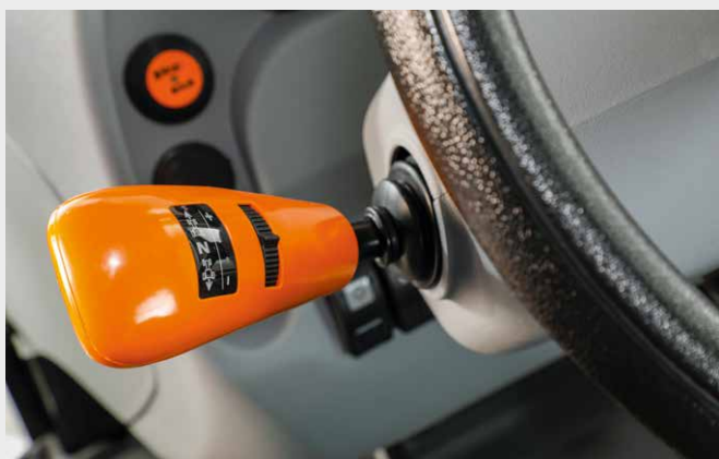
↑ Rewers Powershuttle z pokrętelem regulacji.
