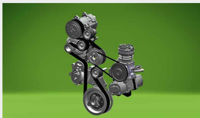
↑ Pasek silnika wzmocniony z układem samoregulacji.
