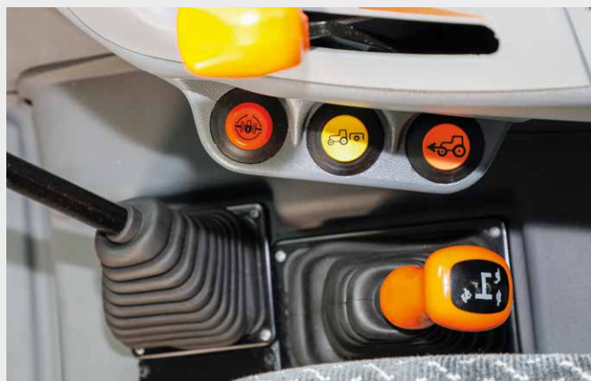
↑ Elektrohydrauliczne sterowanie napędem i blokadą mechanizmów (LS i GS).
