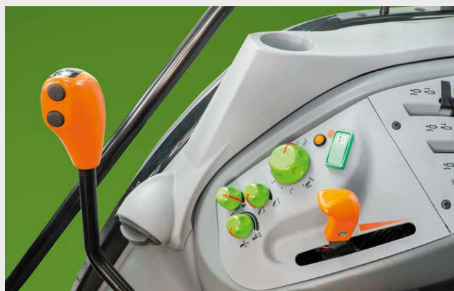
↑ Dźwignia zmiany biegów skrzyni 45+45 z przyciskami do zmiany półbiegów
