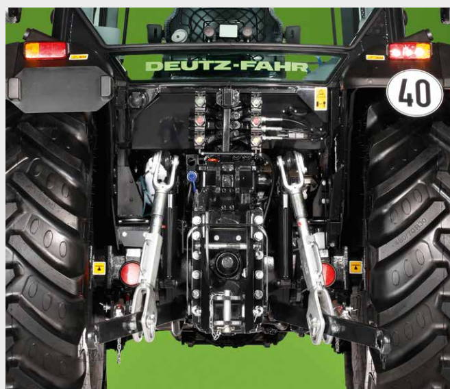
↑ Podnośnik tylny modeli Serii 5D jest dostępny z zaczepami kulowymi jak i automatycznymi.
