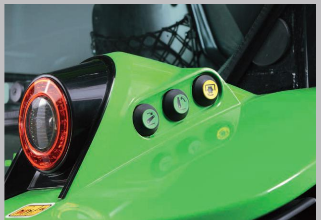
Przyciski do sterowania podnośnika i WOM ułatwiają podłączanie maszyn.
