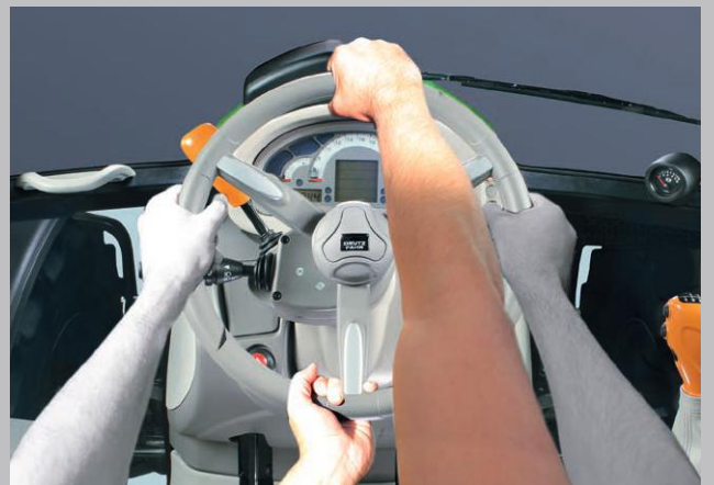
Układ kierowniczy SDD redukujący o połowę liczbę obrotów kołem kierownicy.
