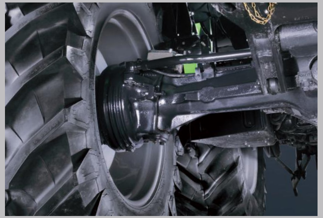
Pełne bezpieczeństwo według DEUTZ-FAHR. Układ hamulcowy z tarczami w kąpiel olejowej na 4 kołach.
