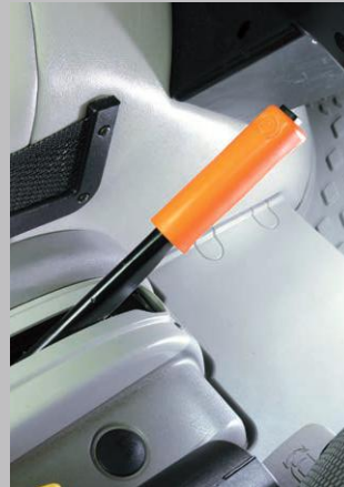
Hamulec postojowy mechaniczny lub hydrauliczny.
