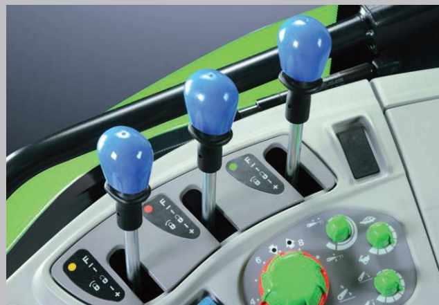
Dźwignie sterowania obwodami hydrauliki. Prostota i precyzja.
