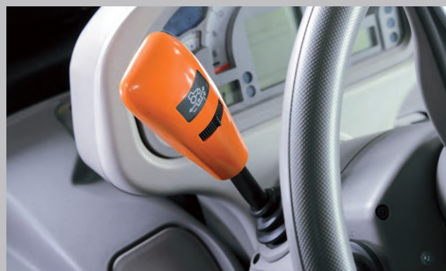
Rewers Powershuttle to wyposażenie standardowe. Pokrętło na dźwigni do regulacji szybkości działania rewesu.
