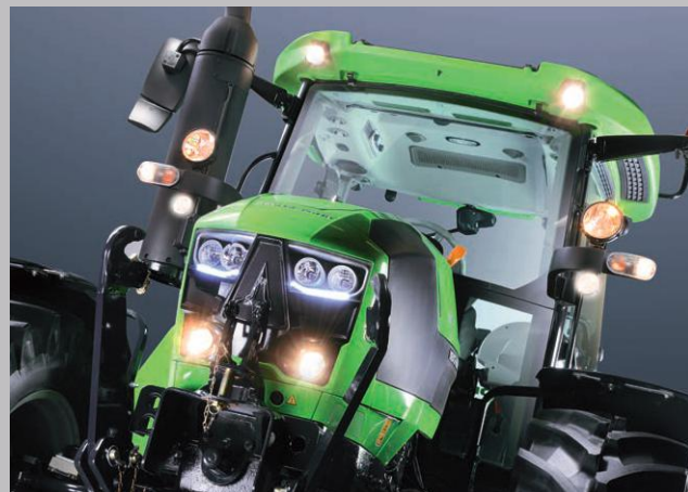
Rozbudowany pakiet reflektorów. Pełna widoczność dookoła ciągnika także w nocy. W masce silnika zamontowano światła LED do jazdy dziennej.
