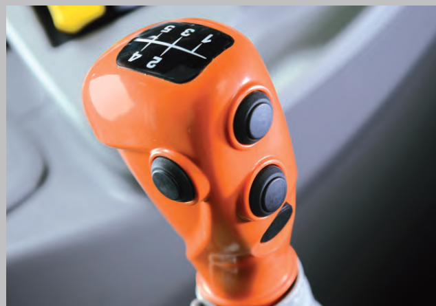
Zmiana biegów z wciśniętym przyciskiem sprzęgła.
