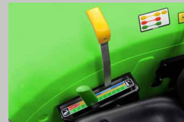
Dźwignie sterowania tylnego podnośnika. Pierwsza określa położenie ramion, druga pozwala korzystać z funkcji podnośnika.
