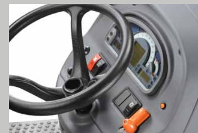
Nowa deska rozdzielcza z wyświetlaczem LCD pokazuje wszystkie niezbędne parametry pracy ciągnika.
