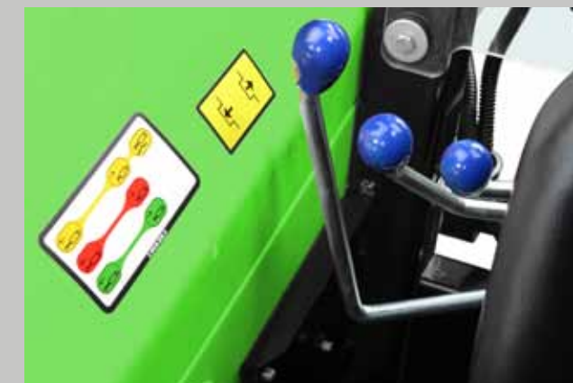
Dźwignie sterowania układu hydraulicznego. Na błotniku umieszczono nowe oznaczenia symbolowe z informacją na temat funkcji obwodów hydrauliki.
