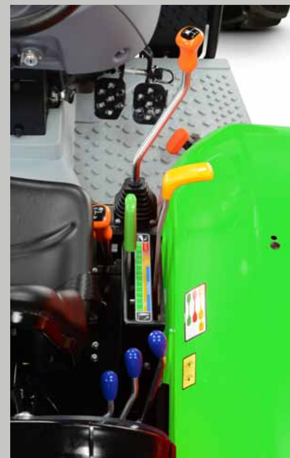
Dźwignie umieszczone po prawej stronie fotela operatora. Obsługa napędu, podnośnika tylnego oraz hydrauliki jest wygodna i precyzyjna.
