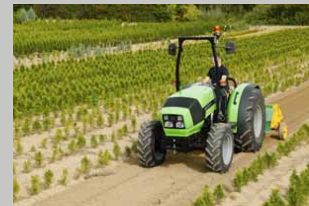
Wersja ze składaną ramą bezpieczeństwa. Rama stanowi standardowe wyposażenie modeli Agropius F Keyline. Po jej złożeniu ciągnik może wjeżdżać przez niskie bramy.
