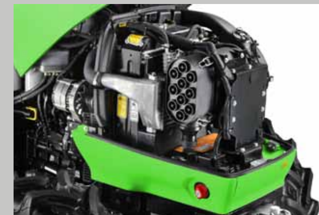
Ekonomiczny silnik FARMotion. W przedniej części komory silnika umieszczono kompaktowy filtr powietrza PowerCore.
