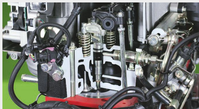
↑ Układ wtryskowy DCR z ciśnieniem 2000 bar zapewnia wydajność i niskie zużycie paliwa.
