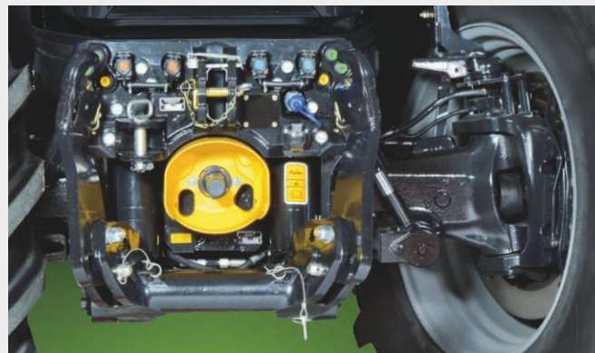
↑ Oś przednia: duży skok układu amortyzacji przy zachowaniu 50° kąta skrętu kół.
