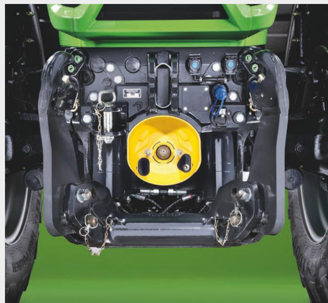
↑ Zintegrowany podnośnik przedni o kompaktowej konstrukcji, składane ramiona.
