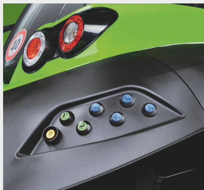
↑ Przyciski sterowania hydrauliką, WOM i podnośnikiem na błotnikach.
