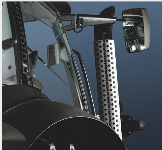
↑ Osłona rury wydechowej ze stali nierdzewnej.
