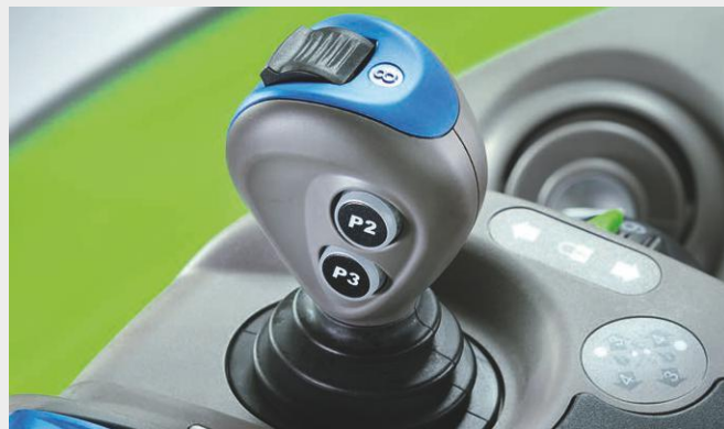
Joystick do sterowania obwodami układu hydraulicznego na podłokietniku.
