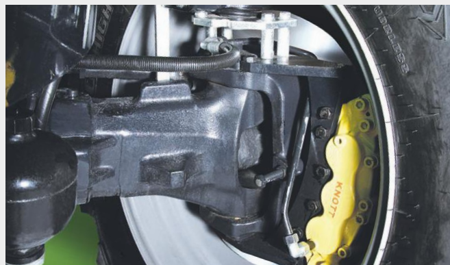
↑ Opcjonalny układ hamulcowy z tarczami i zaciskami na przedniej osi.
