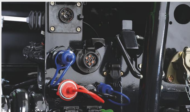
↑ Gniazda ISOBUS montowane z przodu i z tyłu ciągnika – obsługa maszyn różnych producentów.
