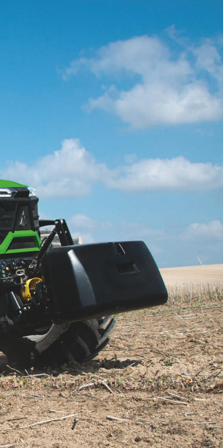
↑ Oś przednia: duży skok układu amortyzacji przy zachowaniu 50° kąta skrętu kół.
