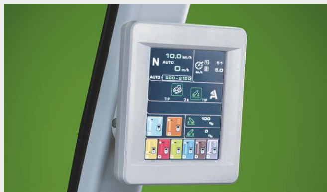
↑ Trzy tryby pracy układu napędowego: manual, auto i WOM. Informacje o działaniu skrzyni na wyświetlaczu na słupku kabiny.
