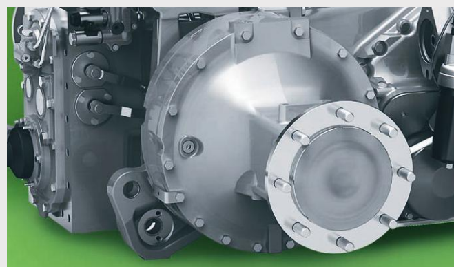
↑ Skrzynia z przekładniami planetarnymi oraz hydrostatem.
