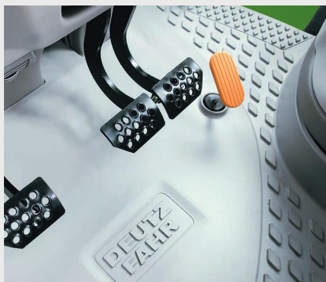
↑ Układ wspomagania hamulców – mała siła na pedale hamulca – ogromna siła hamowania.
