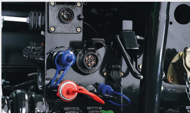
↑ Gniazda ISOBUS montowane z przodu i z tyłu ciągnika pozwalają obsługiwać maszyny różnych producentów.
