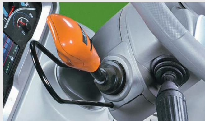
↑ Rewers PowerShuttle i sprzęgła SensClutch – możliwość regulacji szybkości działania rewersu.
