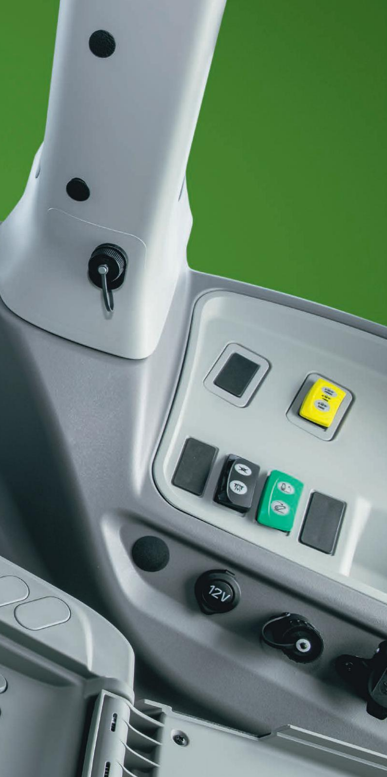
Przyciski sterowania WOM zintegrowane w podłokietniku wielofunkcyjnym ...
