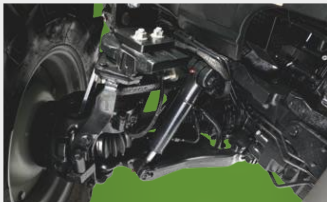
↑ Amortyzowana oś przednia z hamulcami przednimi.
