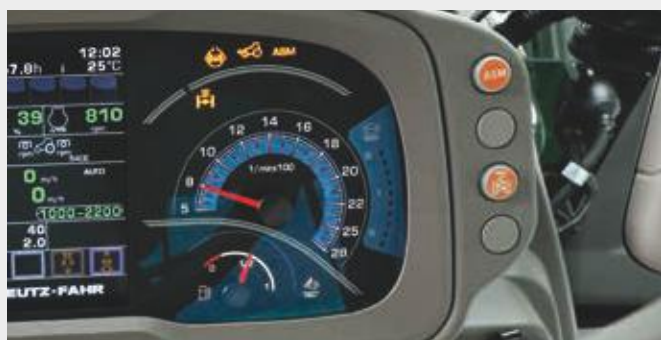
↑ Włączanie systemu ASM i zawieszenia przedniej osi.
