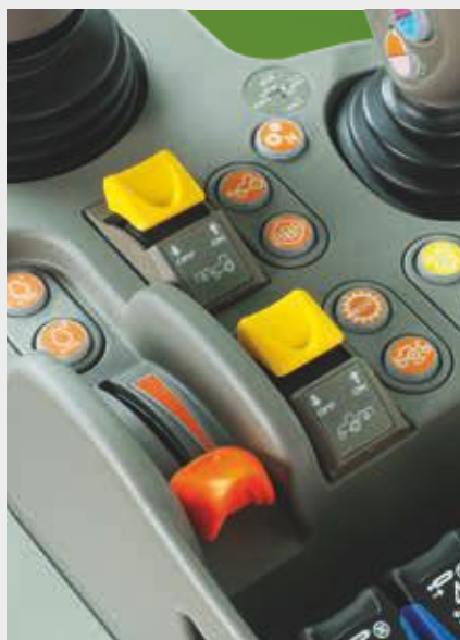
↑ łatwe załączanie przedniego i tylnego WOM przyciskami na podłokietniku MaxCom.
