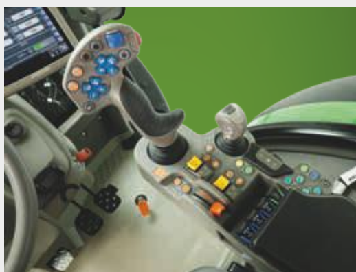
↑ Zaworami hydraulicznymi można łatwo sterować joystickiem.
