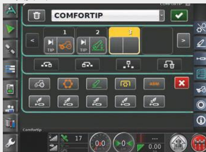
↑ Funkcja Comfortip to jeszcze wyższy poziom komfortu. Umożliwia zapisywanie w pamięci powtarzanych zadań oraz ich wywołanie naciśnięciem przycisku.
