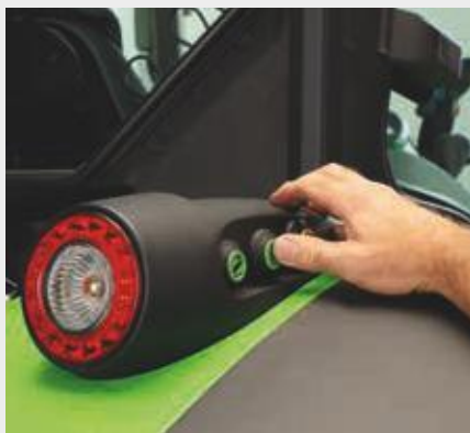
↑ Tylnym podnośnikiem oraz wałkiem WOM steruje się z zewnątrz za pomocą przycisków na tylnych błotnikach
