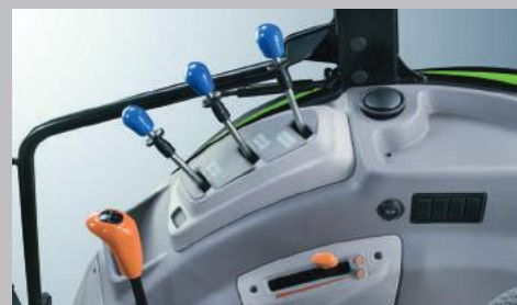
Prawa konsola z dźwigniami sterowania układem napędowym, hydrauliką i WOM.
