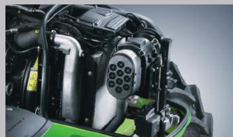
Nowy wentylator silnika ze sprzęgłem Visco oraz wydajny filtr powietrza PowerCore.
