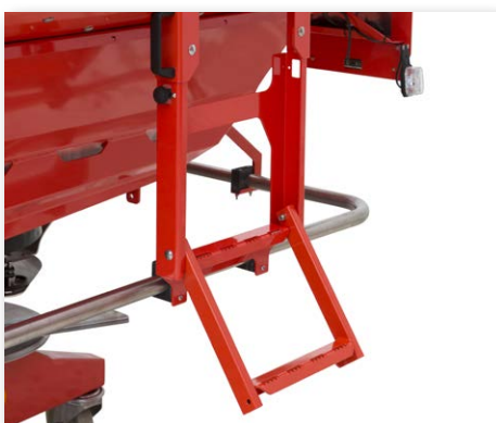
Drabinka do kontroli zbiornika
