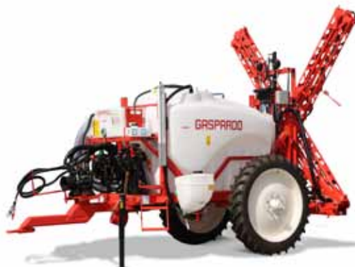
Belka Work X z tylnym układem składania i ostatnią sekcją pionową. Maks. 15 metrów.
