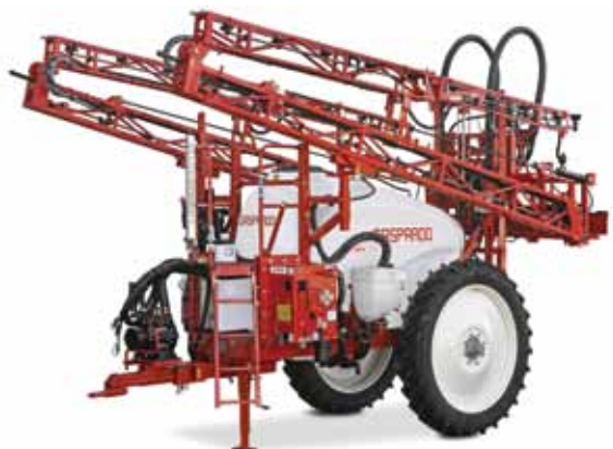
Belka z miechem i bocznym układem składania i ostatnią sekcją pionową. Maks. 21 metrów.
