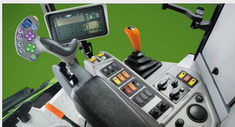
↑ Nowoczesna kabina z nową konsolą i trójpozycyjną regulowaną kolumną kierownicy.
