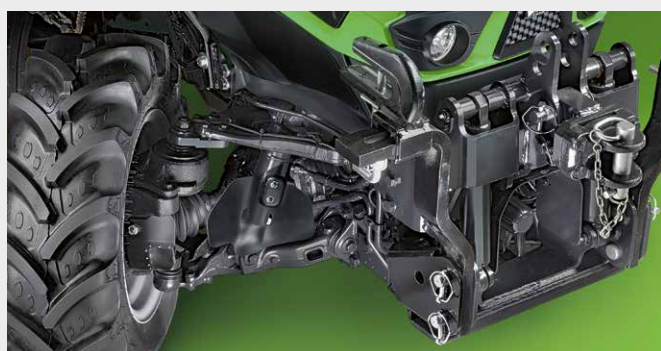
↑ Niezależna amortyzacja kół przedniej osi.
