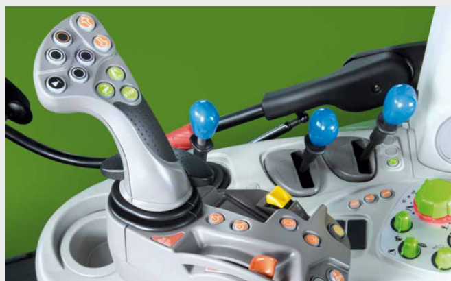
↑ Nowy, niezwykle ergonomiczny joystick MaxCom na podłokietniku steruje głównymi funkcjami ciągnika: od prędkości i kierunku jazdy oraz wyboru tempomatu po sekwencje operacji ComfortTip oraz przedni i tylny podnośnik.
