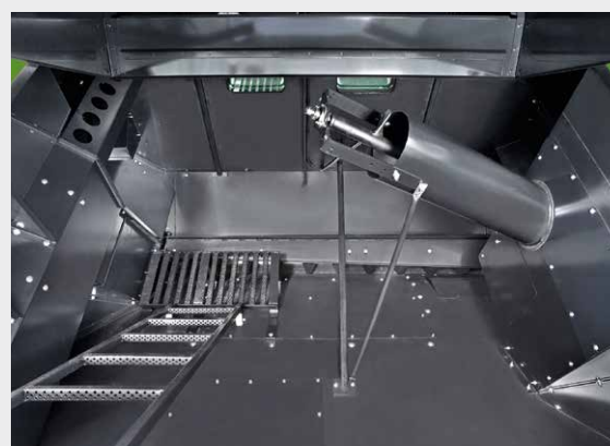
↑ 7000-litrowy zbiornik ziarna w celu ograniczenia przerw przeznaczonych na rozładunek.
