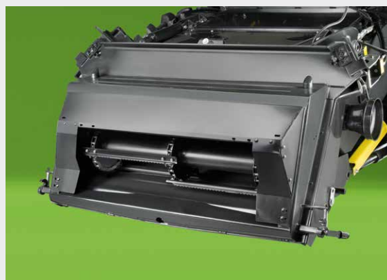
↑ Układ młócający nie jest ograniczony przy obróbce dużych ilości plonów dzięki dużej szerokości podajnika pochylonego.
