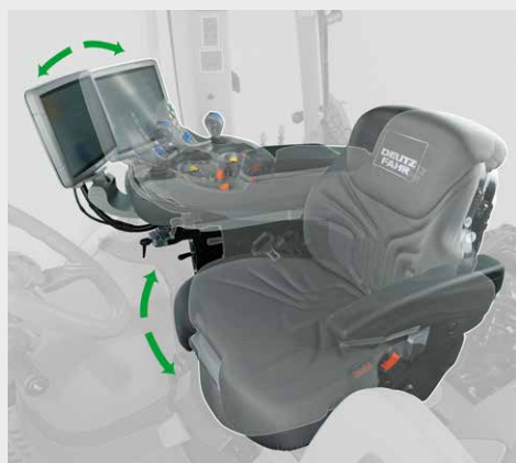
↑ Nowość we wszystkich modelach TTV: fotel z możliwością obrotu o 20° zwiększający komfort pracy.
