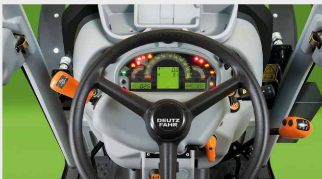
↑ InfoCentre. Wszystkie funkcje ciągnika wyraźnie widoczne. Maksymalna wygoda użytkowania dzięki rewersowi Power Shuttle z dźwignią zamontowaną przy kole kierownicy.
