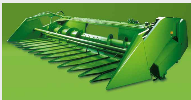
↑ Do zbioru słonecznika przewidziano odpowiedni zestaw, przeznaczony do standardowych hederów DEUTZ-FAHR o szerokości do 7,20 m.
