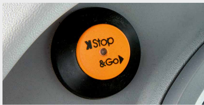
↑ Dzięki funkcji Stop&Go możliwe jest sterowanie ruchem ciągnika wyłącznie pedałami hamulca, bez konieczności dotykania pedału sprzęgła.
