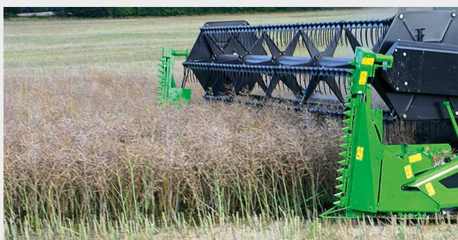
↑ Do zbioru rzepaku przewidziano specjalnie zaprojektowany zestaw, który może być stosowany w standardowych hederach DEUTZ-FAHR o szerokości do 7,2 m.
