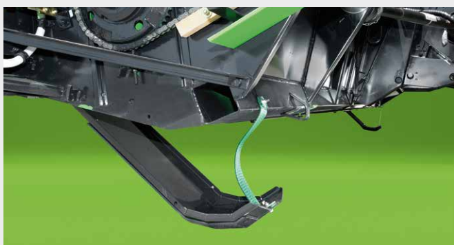
↑ Solidne płyty ślizgowe zawierają czujniki podłoża służące do sterowania położeniem hedera również na nierównym terenie.
