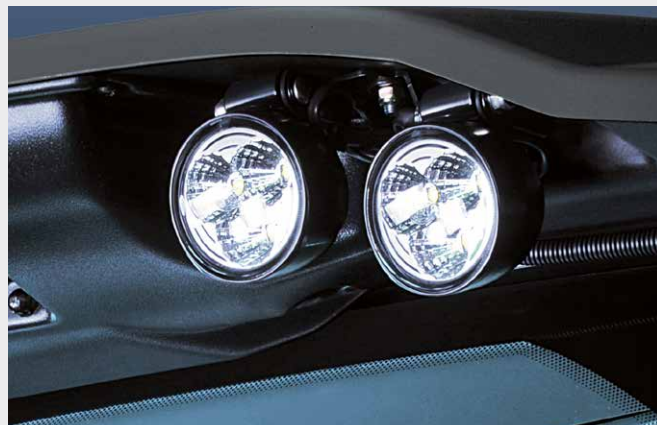
W wyposażeniu standardowym Warrior posiada światła ledowe w dachu.
