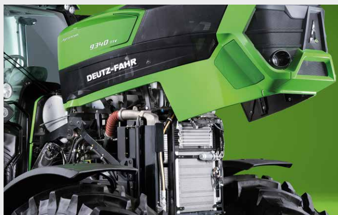
↑ Elektrycznie otwierana pokrywa silnika ułatwia prowadzenie konserwacji.
