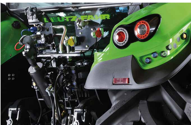
↑ Układ hamulcowy ze sprężonym powietrzem hamuje przyczepy we wszystkich kategoriach masy niezawodny i bezpieczny sposób.
