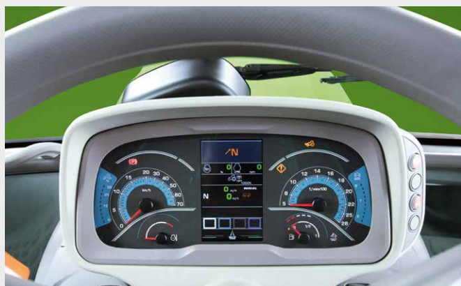
↑ Deska rozdzielcza z nowym InfoCentrePro: 5-calowy, kolorowy ekran LCD o wysokiej rozdzielczości umożliwia odczyt informacji na najwyższym poziomie zgodnie z preferencjami użytkownika.
