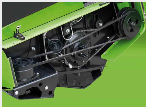
↑ Napęd planetarny C5300 zapewnia wysoką częstotliwość cięcia.
