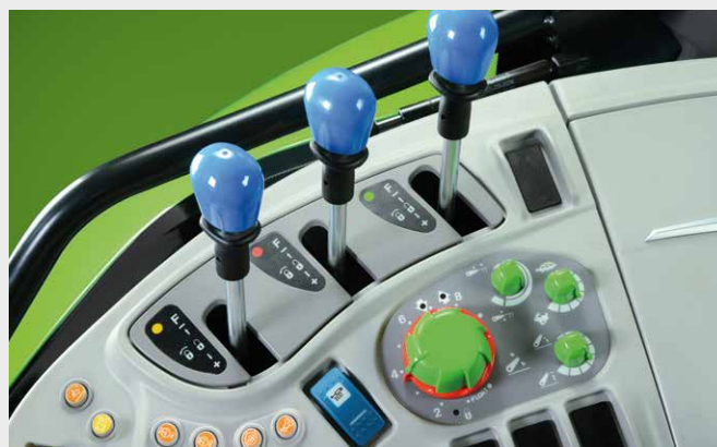
↑ Nowości: dwa ustawienia prędkości obrotowej silnika. Wstępnie zaprogramowana wydajność dla standardowych operacji.
