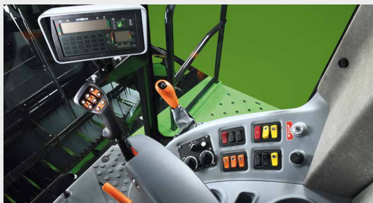
↑ W nowej konsoli roboczej wszystkie elementy sterujące znajdują się w zasięgu operatora. Podłokietnik z dźwignią Commander Stick zapewnia idealny komfort pracy.
