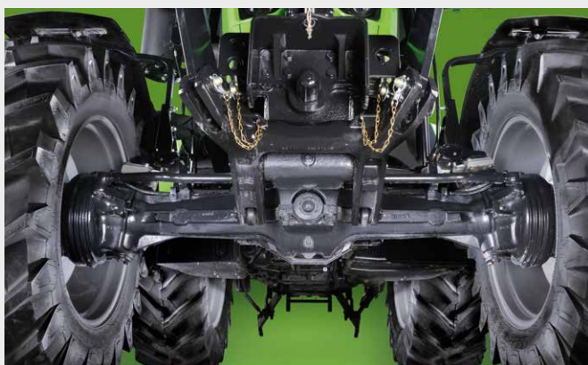
↑ Oś przednia posiada nowe zawieszenie, które zapewnia wyższy komfort jazdy, bezpieczeństwo oraz przyczepność.
