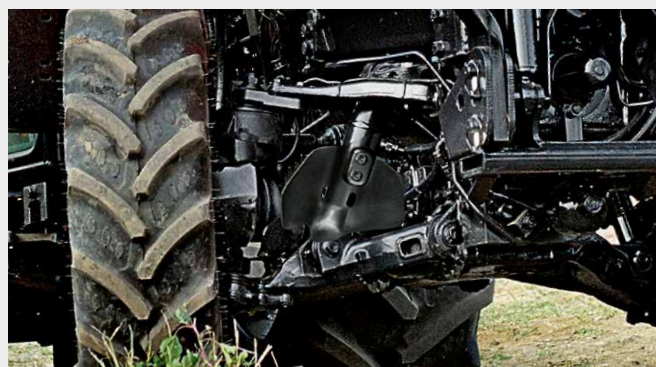
↑ Niezależne zawieszenie kół z podwójnym wahaczem.
