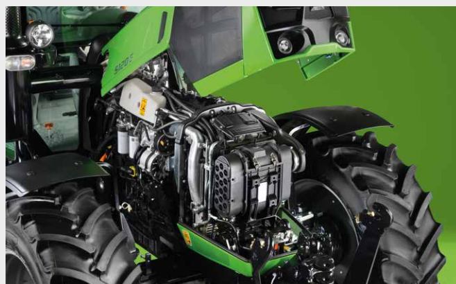
↑ Silnik FARMotion z układem oczyszczania spalin SCR. Modele Stage III B nie wymagają użycia AdBlue.
