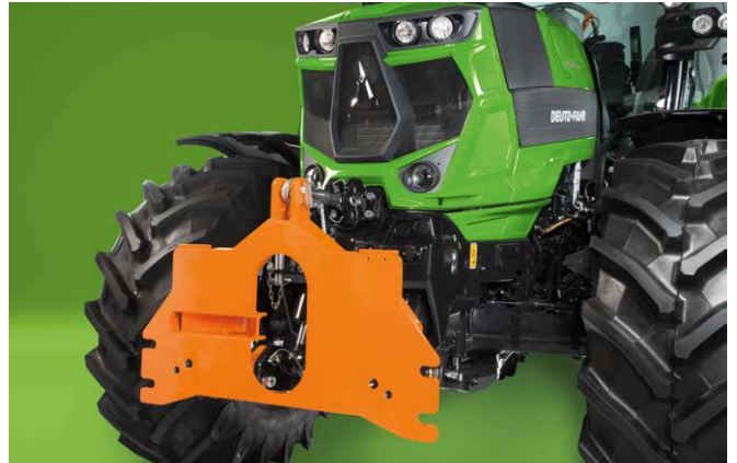
↑ Mocowanie Sauter do celów komunalnych (kategoria 3/5). Do szybkiego i solidnego montażu specjalnego wyposażenia.
