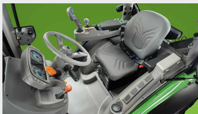
↑ Przestronna 4-słupkowa kabina z całkowicie płaską podłogą dzięki kompaktowej, nisko umieszczonej przekładni TTV.
