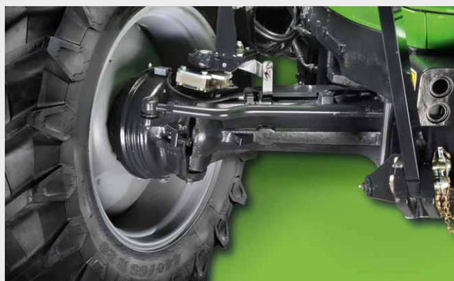
↑ Oś przednia wyposażona w hamulce tarczowe.
