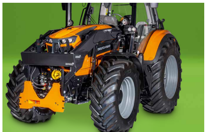
↑ Rama podporowa firmy Sauter z regulowaną paletą do celów komunalnych (kategoria 3/5) oraz podporą osi do dużych obciążeń osprzętu oraz wysięgnika.
