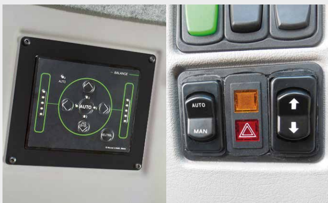
↑ Niezależne sterowanie między przednim systemem BALANCE oraz tylnym systemem poziomowania, zarówno za pomocą funkcji obsługi automatycznej, jak i manualnej.
