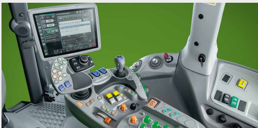
↑ Podłokietnik wielofunkcyjny w Serii 7 TTV zawiera wszystkie główne elementy sterujące oraz umożliwia globalne zarządzanie maszyną.
