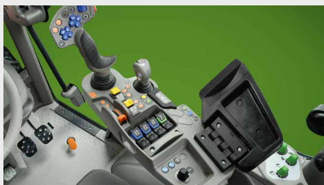
↑ Podłokietnik MaxCom z ergonomicznym joystickiem oraz funkcje przypisywane do dedykowanych przycisków na joysticku.
