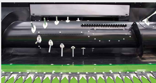
↑ Duża średnica podajnika ślimakowego z regulowanymi palcami ułożonymi spiralnie wzdłuż całej szerokości cięcia.
